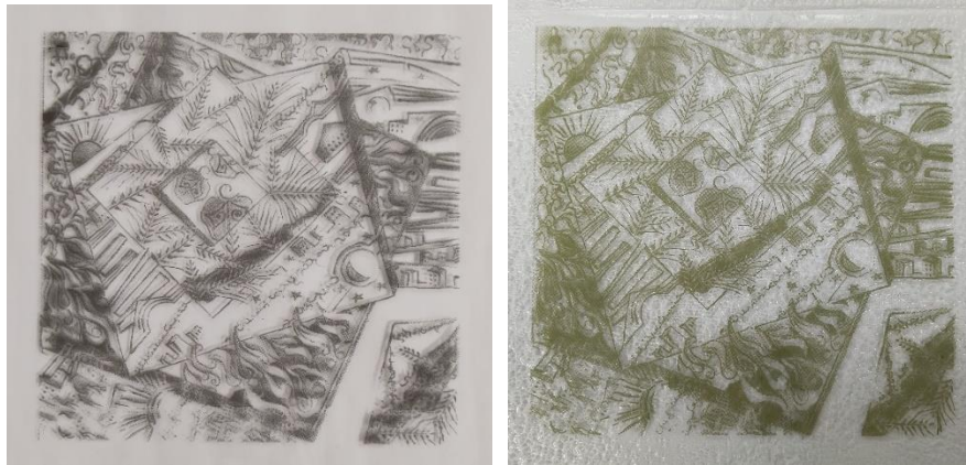
Görsel 4. 86. Direkt baskı, 44 µm nikel 90 T tek çekim, sağda sonuç 800 °C
