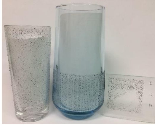
Görsel 4. 72. Endirekt baskı, lak üzerine basılan 44 \mu\text{m} bakır 90 T, sonuç 610 ^{\circ}\text{C}
