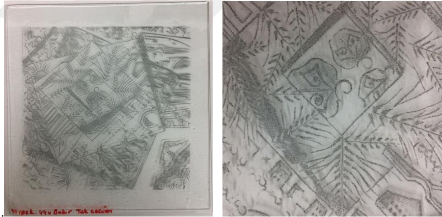
Görsel 4. 84. Direkt baskı, 44 µm bakır 90 T tek çekim, 800 °C, sağda detay
