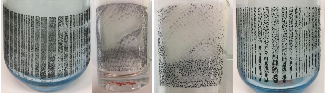
Görsel 4. 63. Endirekt baskı, ısıtılma sonrası sonuç, 650 °C
