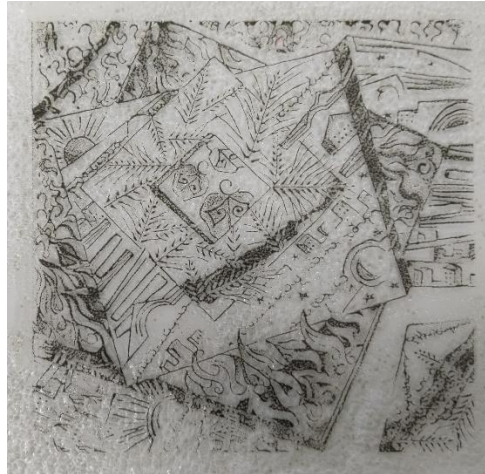
Görsel 4. 88. Direkt baskı, 149 \mu\text{m} nikel 32 T, sonuç 800 °C
