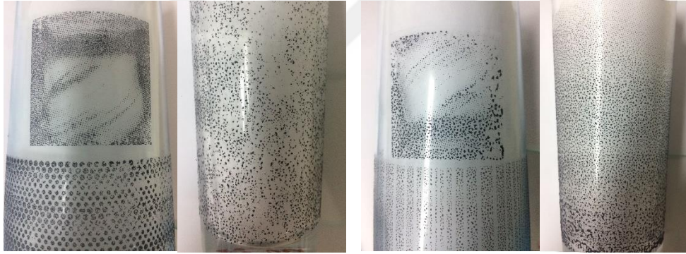
Görsel 4. 65. Endirekt baskı, Adolin ve Casati vernik ısıl işlem sonrası sonuç, 650 °C
