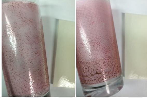
Görsel 4. 75. Endirekt baskı, Akçalı vernik üzerine 44 µm bakır 90 T, 650 °C
