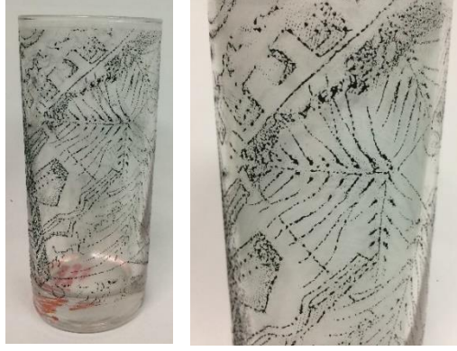
Görsel 4. 90. Direkt baskı, 44 µm demir 90 T, Akçalı vernik üzerine baskı, sonuç 650 °C, sağda detay
