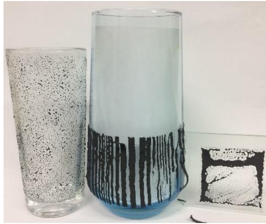
Görsel 4. 71. Endirekt baskı, lak üzerine basılan 44 µm bakır 32 T, sonuç 610 °C
