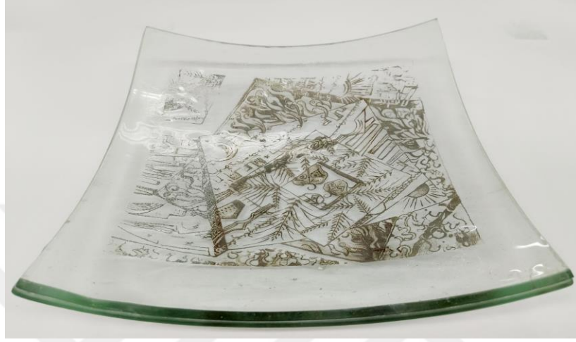
Görsel 4. 105. Isıl işlem sonrası sonuç, 610 °C, 705 °C ve 760 °C
