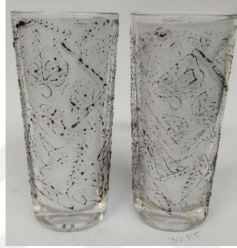
Görsel 4. 96. Endirekt baskı, 149 µm nikel 32 T, sağdaki bardak fritli sonuç, 650 °C
