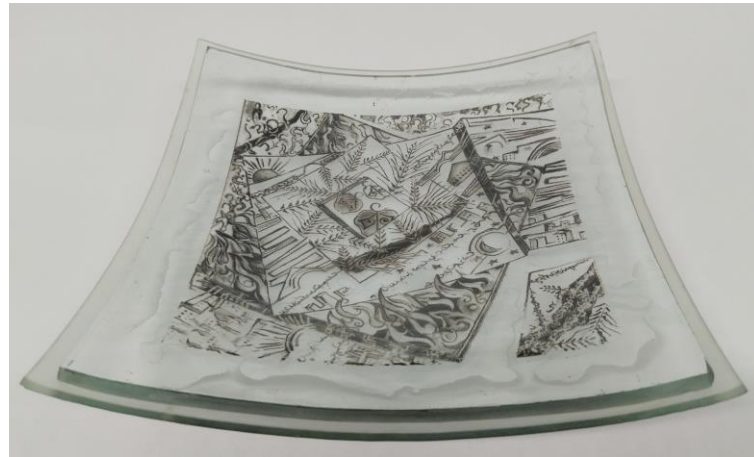
Görsel 4. 102. Isıl işlem sonrası sonuç, 760°C
