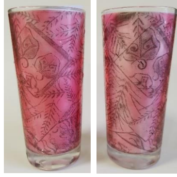
Görsel 4. 93. Endirekt baskı, 44 \mu\text{m} nikel 90 T, Adolin vernik üzerine ve fritli baskı, 650 °C
