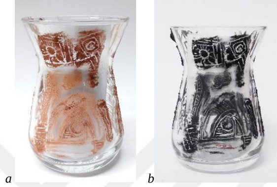
Görsel 4. 17. a- Isıl işlem öncesi bakır tozu b- Isıl işlem sonrası bakır tozu, 600 °C
