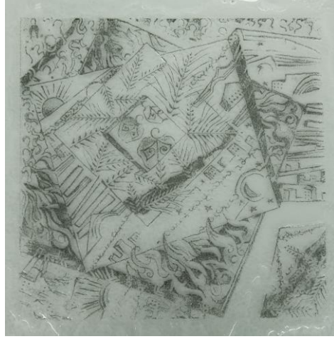
Görsel 4. 89. Direkt baskı, 149 µm nikel 32 T, kumlama
