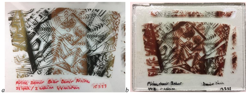
Görsel 4. 99. a-Direkt baskı, 44 \mu m metal tozları 32 T iki çekim b-Isıl işlem sonrası sonuç, 800 °C
