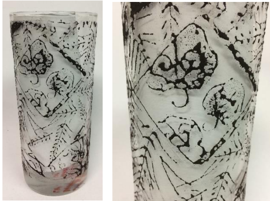
Görsel 4. 91. Direkt baskı, 44 µm demir 32 T, Akçalı vernik üzerine baskı, sonuç 650 °C, sağda detay
