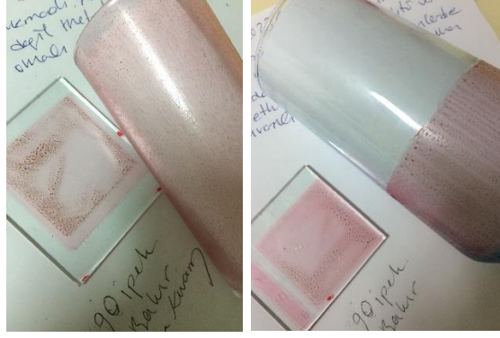
Görsel 4. 70. Endirekt baskı, lak üzerine basılan 44 µm bakır 90 T, 610 °C
