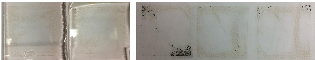
Grsel 4. 60. Endirekt baskı, 90 T ile 44 m bakır, borosilikat ve pencere camı, sonu 610  C
