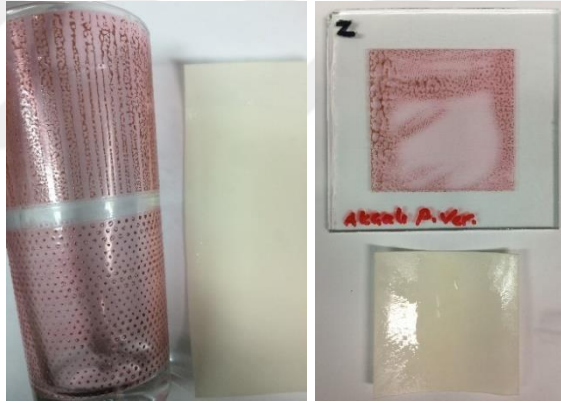
Görsel 4. 76. Endirekt baskı, Akçalı vernik üzerine 44 µm bakır 90 T, 650 °C
