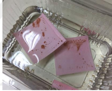
Görsel 4. 68. Endirekt baskı, lak üzerine basılan 44µ bakır, 610 °C
