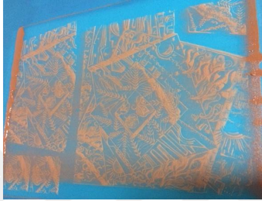
Görsel 4. 79. Kalıp üzerinde rakle ile ilk çekim.
