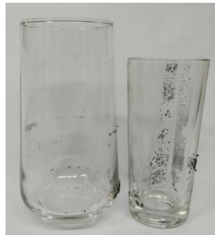
Görsel 4. 74. Endirekt baskı, 44 \mu\text{m} nikel 90 T, sonuç 650 ^{\circ}\text{C}
