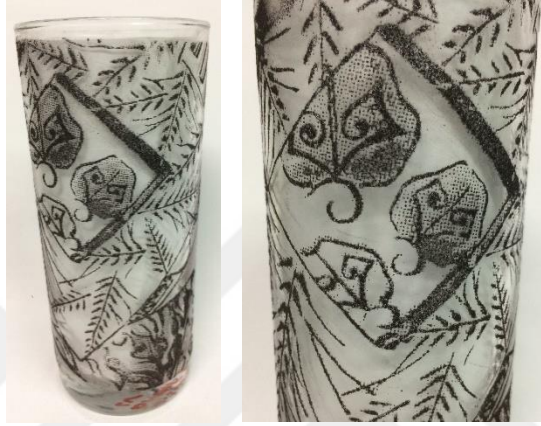
Görsel 4. 92. Direkt baskı, 44 µm demir 90 T, Adolin vernik üzerine baskı, sonuç 650 °C, sağda detay
