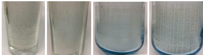
Grsel 4. 59. Endirekt baskı, 90 T ile 44 m bakır, sonu, 610  C
