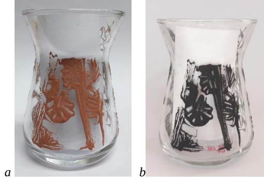
Görsel 4. 8. a- Isıl işlem öncesi bakır tozu b- Isıl işlem sonrası bakır tozu, 500 °C
