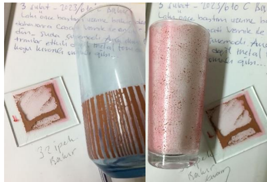
Görsel 4. 69. Endirekt baskı, lak üzerine basılan 44 µm bakır 32 T, 610 °C
