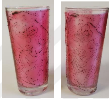
Görsel 4. 94. Endirekt baskı, 149 \mu\text{m} nikel 32 T, Adolin vernik üzerine ve fritli baskı, 650 °C
