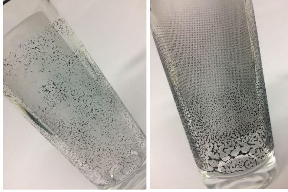
Görsel 4. 77. Endirekt baskı, Akçalı vernik üzerine 44 µm bakır 90 T, sonuç 650 °C
