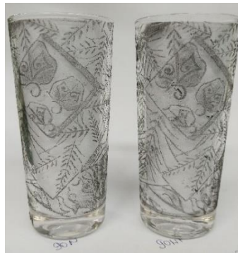
Görsel 4. 95. Endirekt baskı, 44 \mu\text{m} nikel 90 T ve fritli sonuç, 650 °C
