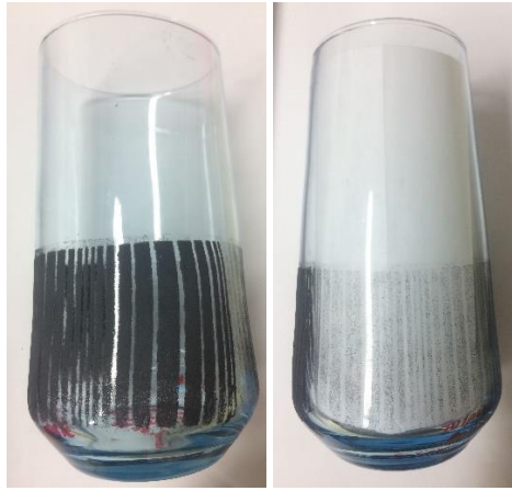
Görsel 4. 67. Endirekt baskı, ısıt işlem sonrası sonuç, 650 ^{\circ}\text{C}
