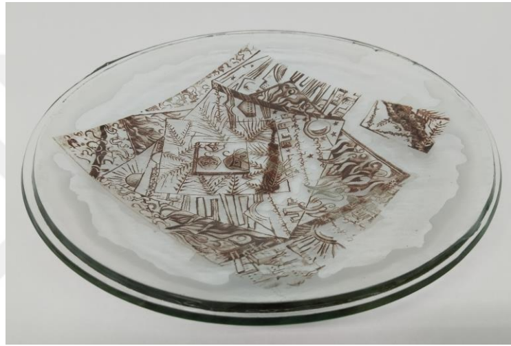
Görsel 4. 103. Isıl işlem sonrası sonuç, 760°C
