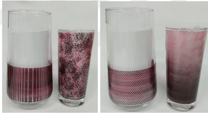
Görsel 4. 73. Endirekt baskı, 44 \mu\text{m} nikel 90 T, 650 ^{\circ}\text{C}
