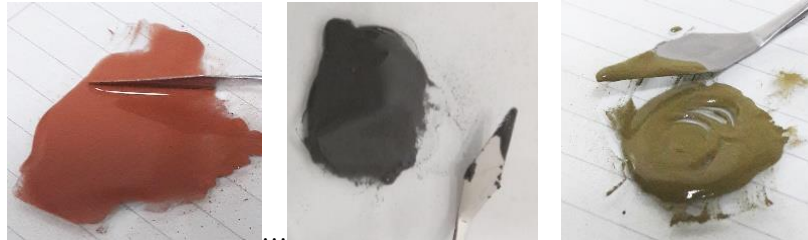
Görsel 4. 4. Medyum ile elde edilmiş kıvamlı metal partikülleri (Fotoğraf: Gülhan Karabulut)
