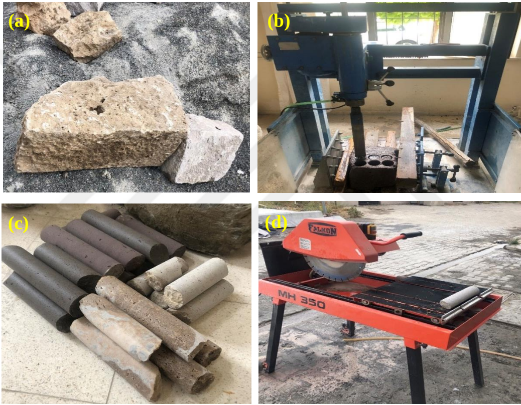
Şekil 3.1. Laboratuvar deneylerine numune hazırlanması (a) Taş bloklar (b) Karot alma işlemi (c) Silindirik karot numuneler (d) Kesme işleminde kullanılan alet
