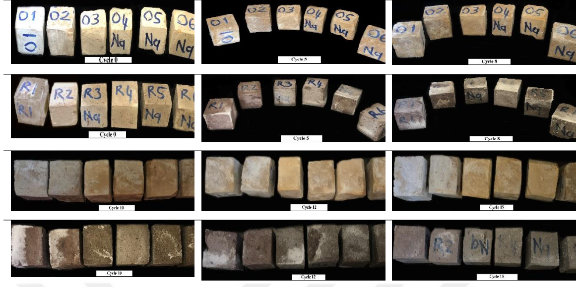
Şekil 3.22. Tuz Kristalizasyon etkisi altında OT ve RT numunelerinde meydana gelen görsel değişimler
