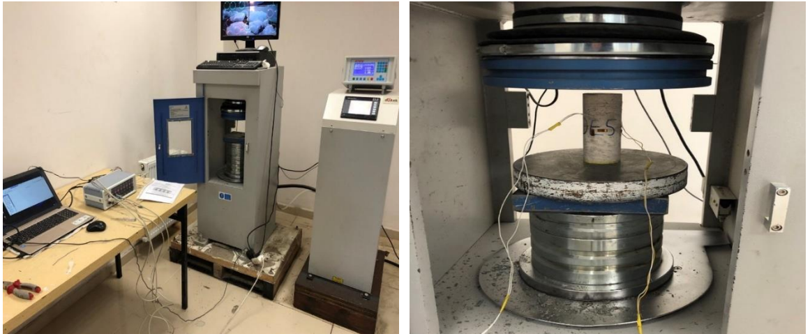
Şekil 3.3. Tek eksenli basınç dayanımı deney düzeneği ve gerinim pulları
