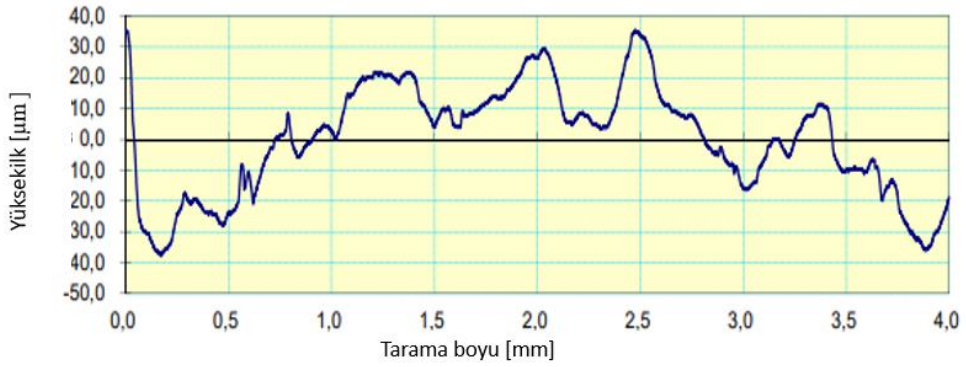
Görsel 2.5. Yüzey izlerinden 2B taranan bir profil
