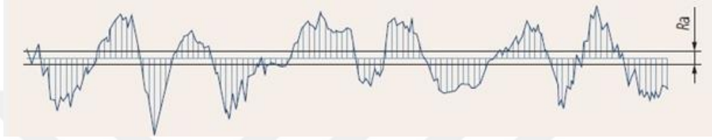
Görsel 2.9. Yüzey pürüzlülüğü şematik gösterimi
