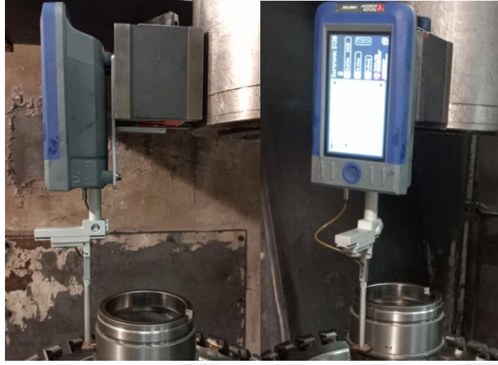
Görsel 3.6. Deney setinde yüzey kalitesi ölçümü
