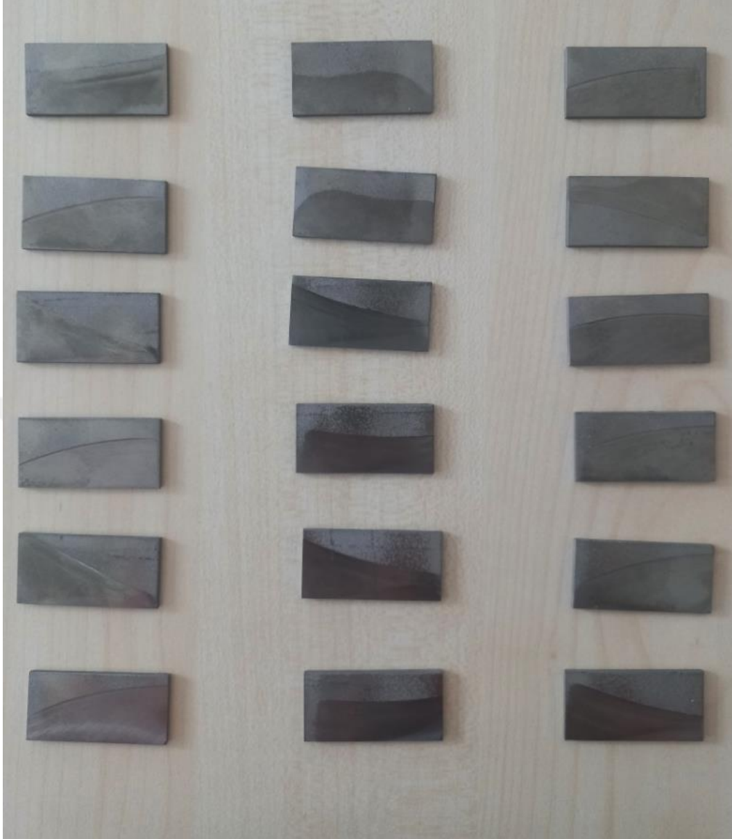
Görsel 4.29. Farklı parametrelerle taşlanmış test kuponları
