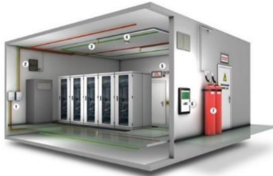
Şekil 3.25. Gaz Söndürme Sistemi
