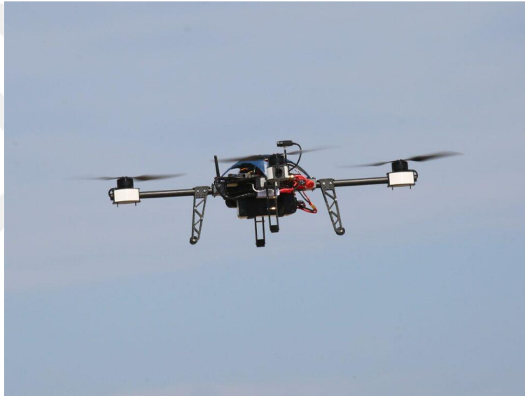
Şekil 3.5. Döner Kanatlı İnsansız Hava Aracı
