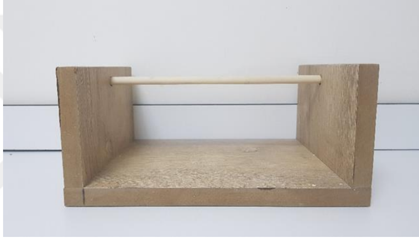
Şekil 7: Çubuk katalepsi testlerinde kullanılan deney düzeneği
