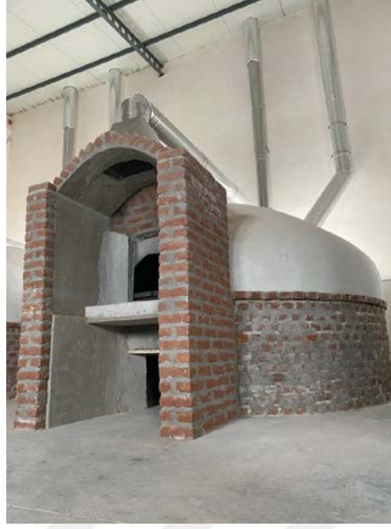
Resim 2.1. Saman Ateşi Kullanılarak Yakılan Kubbeli Fırın
