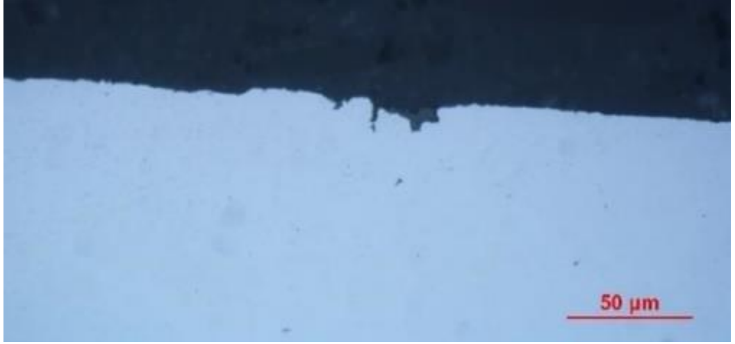
Şekil 6.9. Hasarlı bagenin aşınma yüzeyi (500X) [35]
