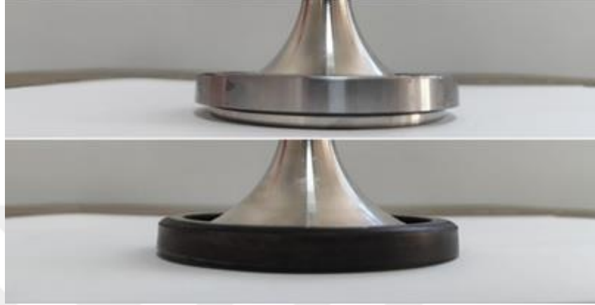
Şekil 6.2. Kullanılmamış ve hasarlı baganın sırasıyla supapla ilişkisi
