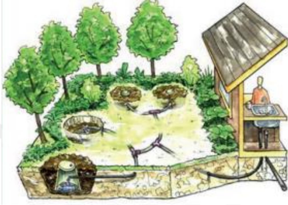
Şekil 2.20 : Lavabodan kaynaklanan grisuyun doğrudan sulama suyu olarak kullanılması (SYGM, 2022).
