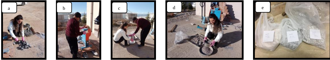
Şekil 3.18. a) Kırıcı için kayaların küçültülmesi b) Küçültülen kayaların kırıcıya yerleştirilmesi c) Kırıcıdan çıkan kayaç agregaları d) Kayaç agregalarının eleyerek ayrıştırılması e) Ebatlarına göre paketlenen kayaç agregaları
