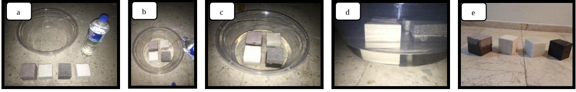
Şekil 3.24. a) Pas tutma deneyi için hazırlanan deney düzeneği b) Kayaç numunelerine yüzeylerinin tam oturduğu deney kabında su eklenmesi c) Kayaç numunelerinin yarısına kadar su eklenmesi d) Her bir kayaç için %50 seviyesinin kontrol edilmesi e) %50 seviyesine kadar su dolu bekletilen kayaçların su içinde olan kısmı ile olmayan kısmının kıyaslanması
