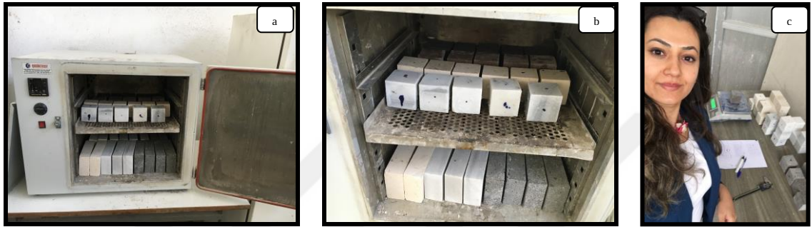
Şekil 3.11. a) Etüve yerleştirilen kayaçlar b) Etüve kuruyan kayaçlar c) Kuru ağırlık ölçümü
