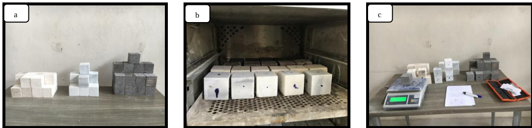
Şekil 3.12. a)Deney için hazırlanan kayaçlar b) Etüve yerleştirilen kayaçlar c)Kuru ağırlık ölçümü
