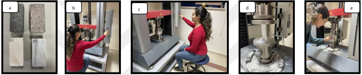
Şekil 3.20. a) Basma dayanımı deney düzeneği için hazırlanan kayaç numuneleri b) Deney cihazının kayaç şekline göre ayarlanması c) Deney cihazının çalıştırılması d) Kayaçların basma deneyi sonrasındaki görünümü e) Deney sonrası kırılan kayaçların incelenmesi
