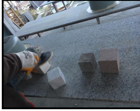
Şekil 3.23. Hazırlanan kayaç numunelerinin cila tutma deneyi
