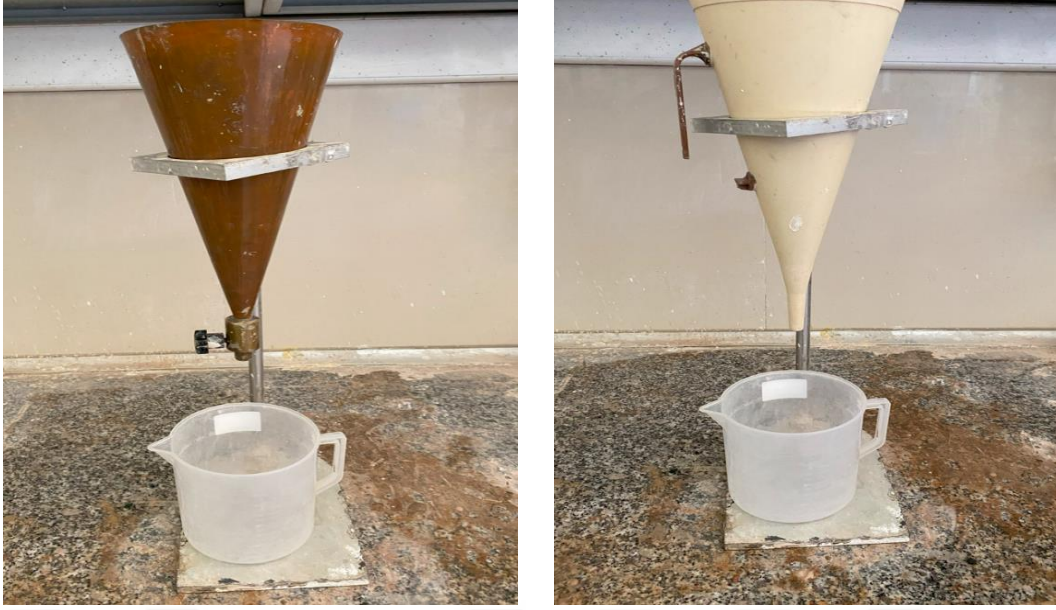
Şekil 3.6 Akış konisi ve Marsh hunisi
