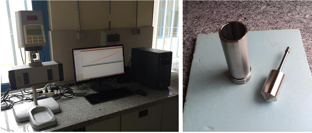
Şekil 3.10 Anton Paar Reolab QC reometre ve tek eksenli silindirik ölçüm ucu [48]
