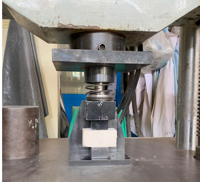
Şekil 3.17 Basınç dayanım deneyi
