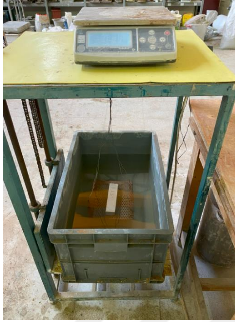
Şekil 3.14 Suya doymun haldeki numunelerin suda tartılmaları ( W_{ss} ölçümü)
