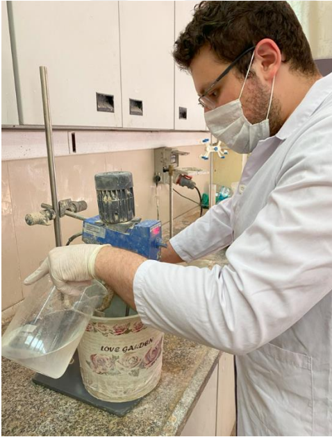
Şekil 3.5 NFS katkılı kireç esaslı enjeksiyon malzemelerinin üretimi
