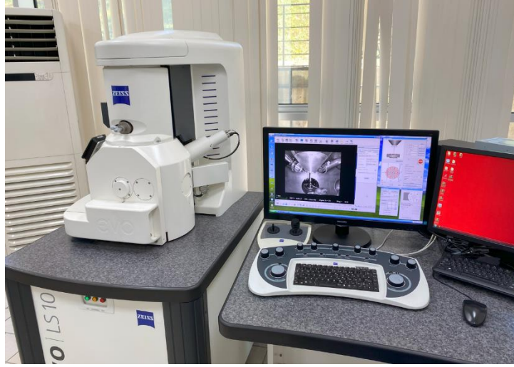
Şekil 3.21 Taramalı elektron mikroskobu
