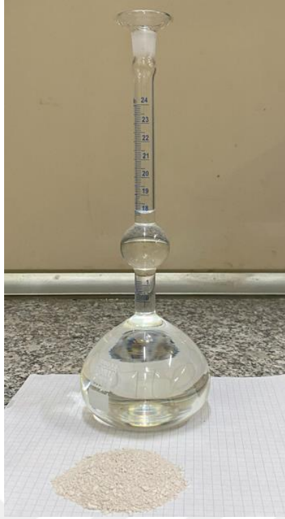
Şekil 3.15 Le Chatelier balonu ve toz numune (<63µm)
