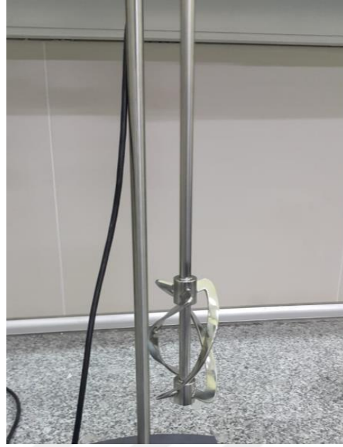
Şekil 3.4 Spiral uçlu mekanik mikser
