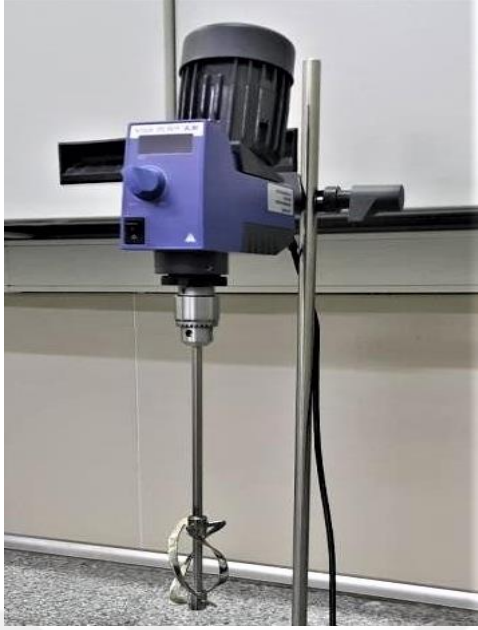
Şekil 3.4 Spiral uçlu mekanik mikser
