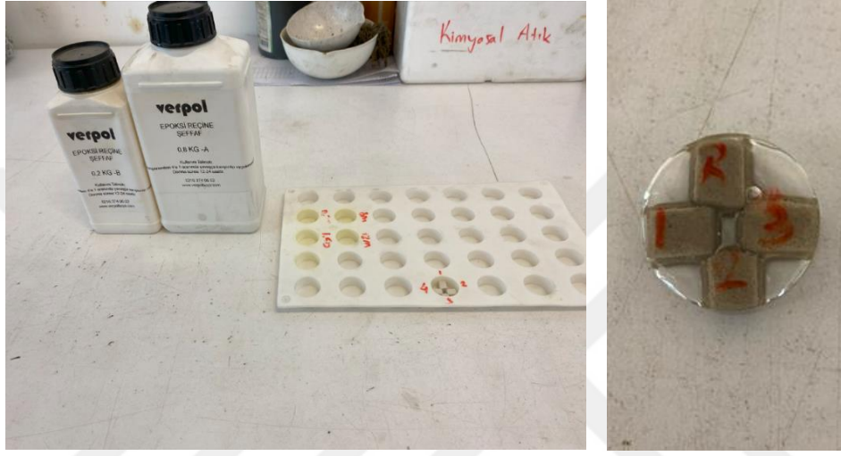
Şekil 3.19 Numunelere şeffaf epoksi reçine tabanlık yapılması
