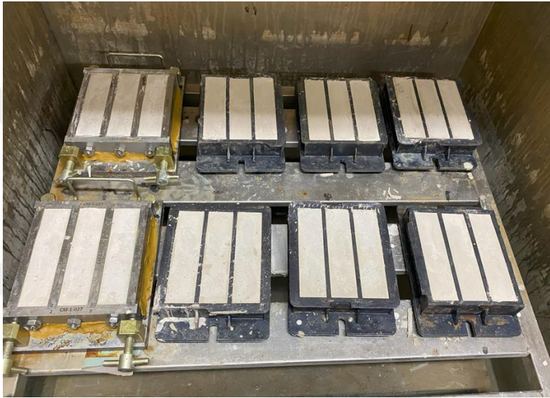
Şekil 3.11 Enjeksiyon malzemelerinin küre tabi tutulması
