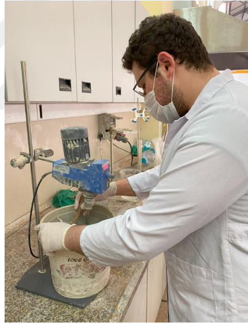
Şekil 3.5 NFS katkılı kireç esaslı enjeksiyon malzemelerinin üretimi
