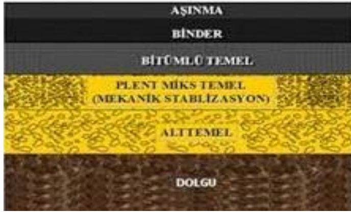
Resim 3.1 Esnek Üstyapı Enkesiti
