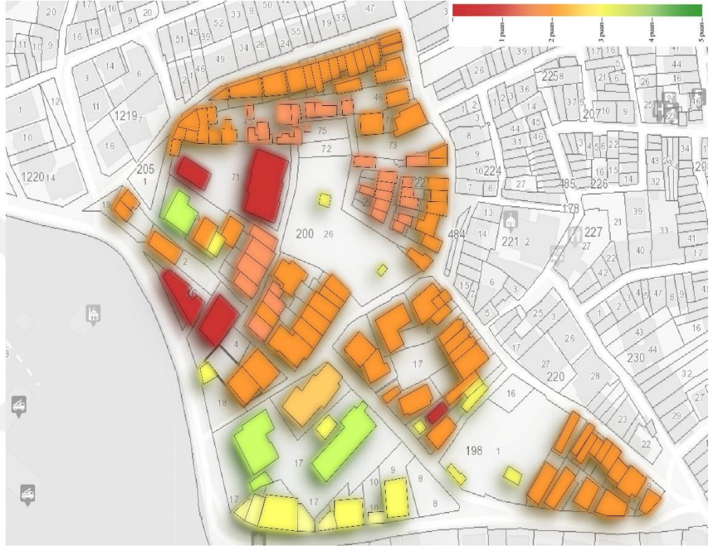
Şekil 25 Mecidiye Mahallesi Yangın Risk Haritası
