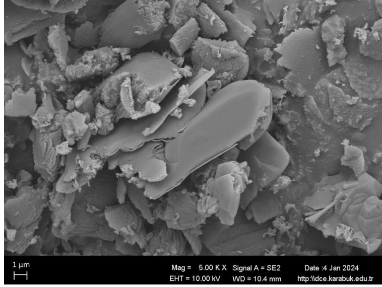
Şekil 5.18. g-C 3 N 4 nano partikülünün 5kx SEM görüntüsü.
