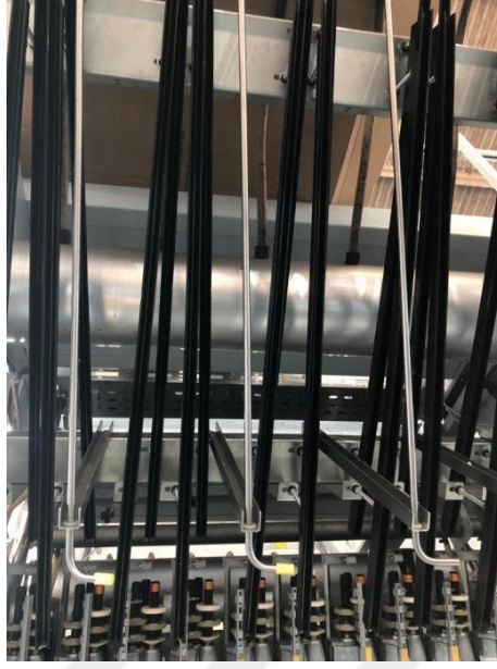
Şekil 2.6. Yalancı büküm yöntemi ile tekstüre makinesinde bulunan soğutma plakası
