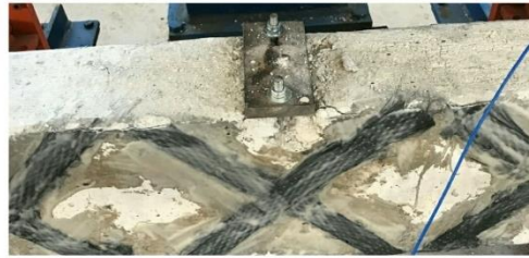
Şekil 4.53. B1-7 deney elemanında oluşan ilk hasar durumu
