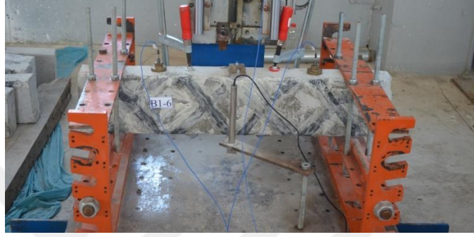
Şekil 4.44. B1-6 deney elemanı çarpma deneyi
