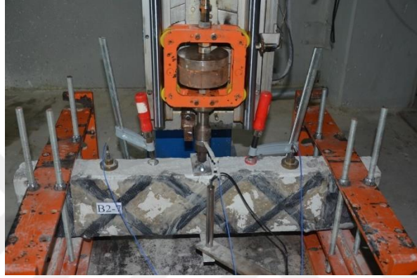
Şekil 4.108. B2-7 deney elemanı çarpma deneyi
