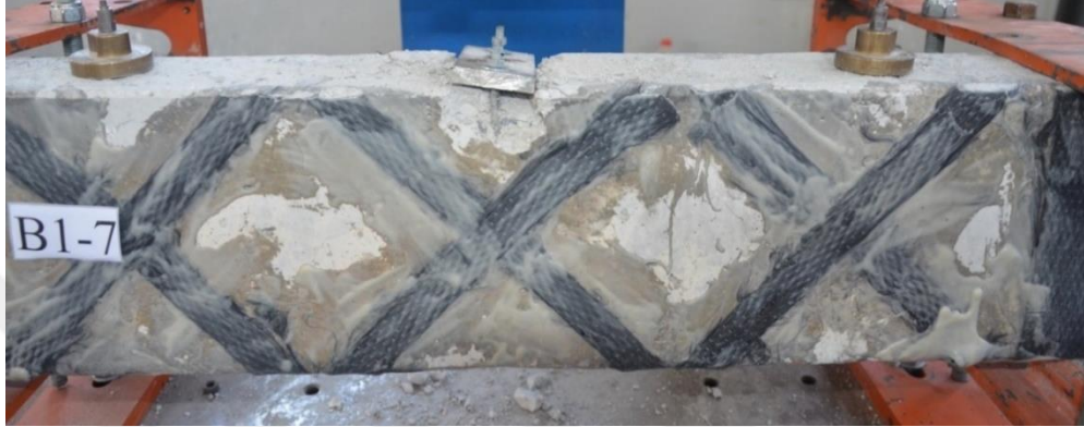
Şekil 4.54. B1-7 deney elemanında oluşan göçme hasar durumu
