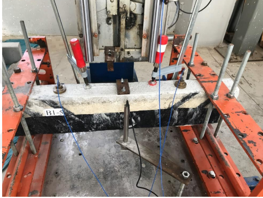
Şekil 4.36. B1-5 deney elemanı çarpma deneyi
