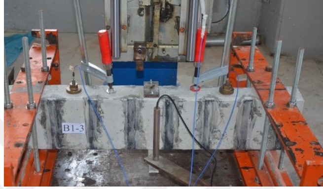
Şekil 4.20. B1-3 deney elemanı çarpma deneyi
