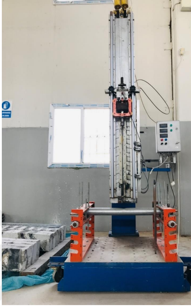
Şekil 3.4. Serbest ağırlık düşürücü deney düzeneği
