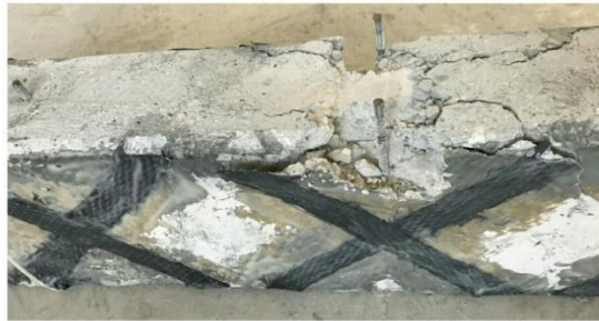
Şekil 4.55. B1-7 deney elemanının deney sonrası agrega-matris görünümü
