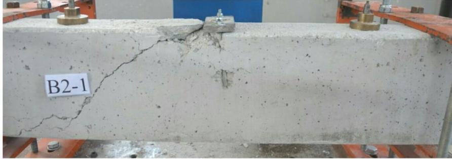
Şekil 4.62. B2-1 deney elemanında oluşan göçme hasar durumu
