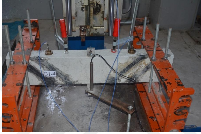
Şekil 4.28. B1-4 deney elemanı çarpma deneyi
