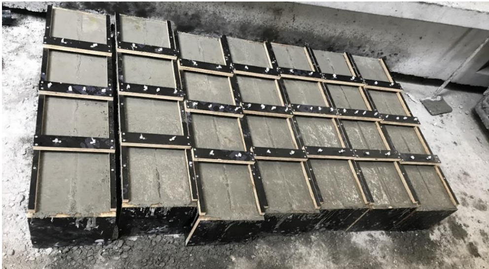
Şekil 3.21. Deney ölçüm cihazı montaj vidaları yerleştirilmiş deney elemanları
