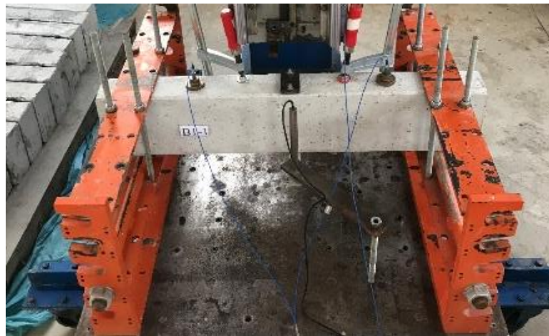
Şekil 4.4. B1-1 deney elemanı çarpma deneyi
