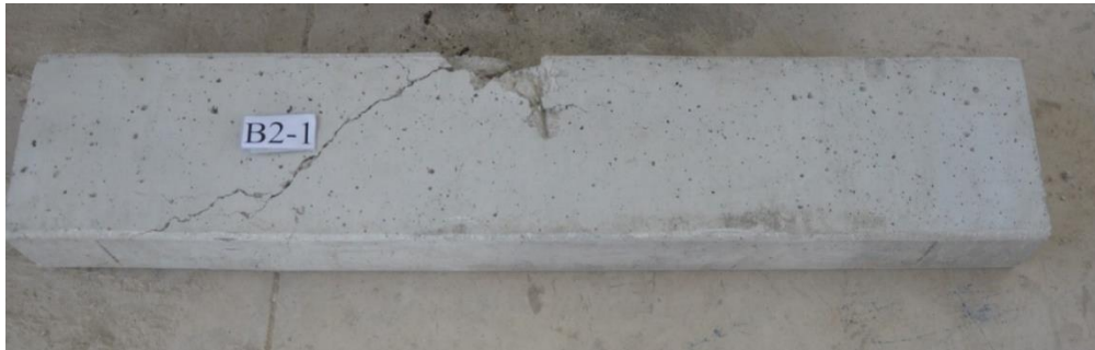
Şekil 4.63. B2-1 deney elemanının deney sonrası agrega-matris görünümü
