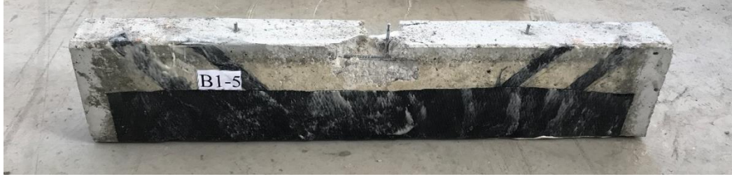
Şekil 4.39. B1-5 deney elemanının deney sonrası agrega-matris görünümü
