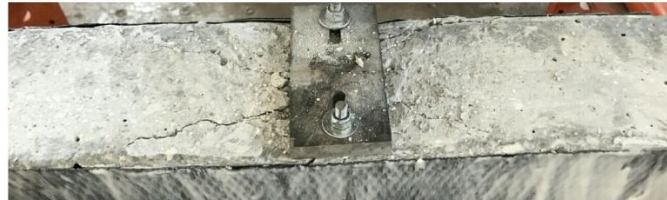
Şekil 4.69. B2-2 deney elemanında oluşan ilk hasar durumu
