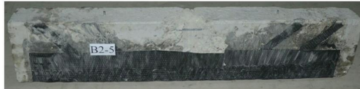
Şekil 4.94. B2-5 deney elemanında oluşan göçme hasar durumu
