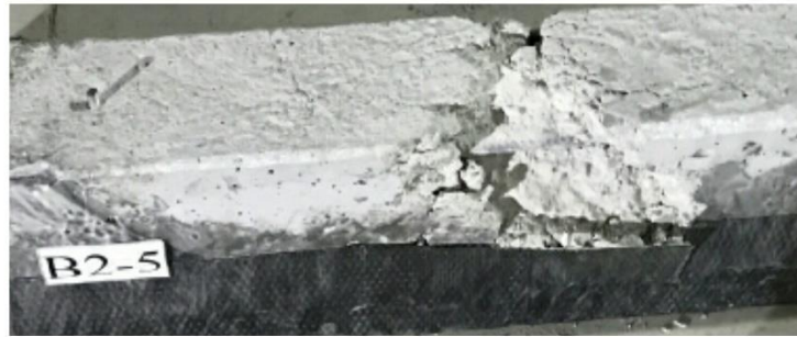
Şekil 4.95. B2-5 deney elemanının deney sonrası agrega-matris görünümü
