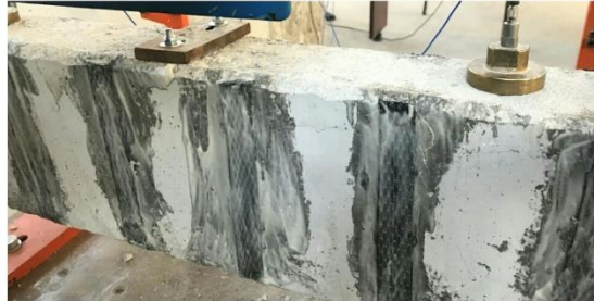
Şekil 4.77. B2-3 deney elemanında oluşan ilk hasar durumu
