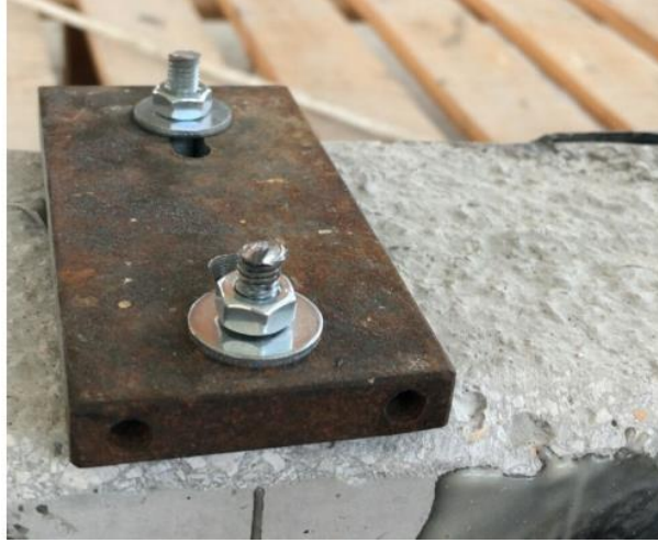
Şekil 3.3. Deneyde kullanılan çelik plaka ve kirişe monte edilmiş hali
