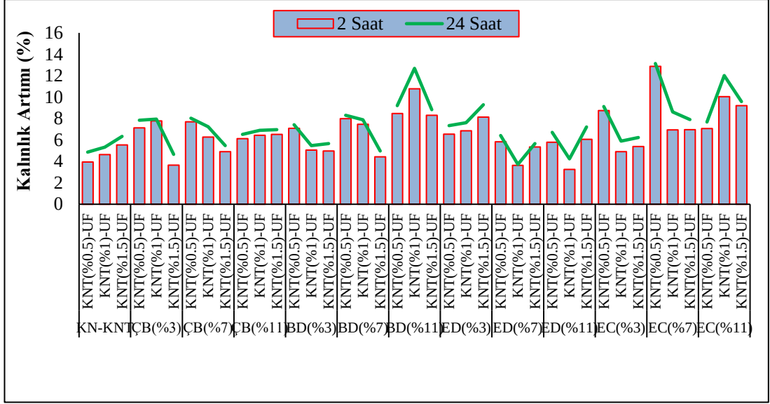
Şekil 4.22. UF'lu serilerde KNT oranı, bor türü ve oranına göre 2 ve 24 saat kalınlık artımı sonuçları
