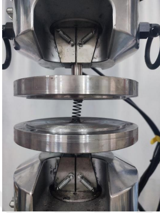
Şekil 3.20. Basma testi yapılan ana sistemdeki yay.
