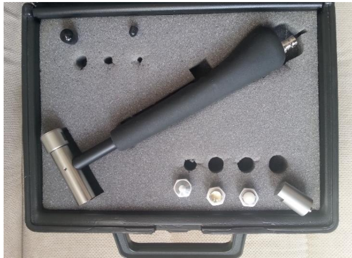
Şekil 3.11. Deneyisel modal analizde kullanılan modal çekiç.
