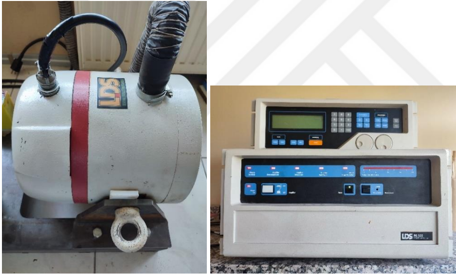
Şekil 3.15. Modal sarsıcı ve modal sarsıcıya ait güç yükselticisi.
