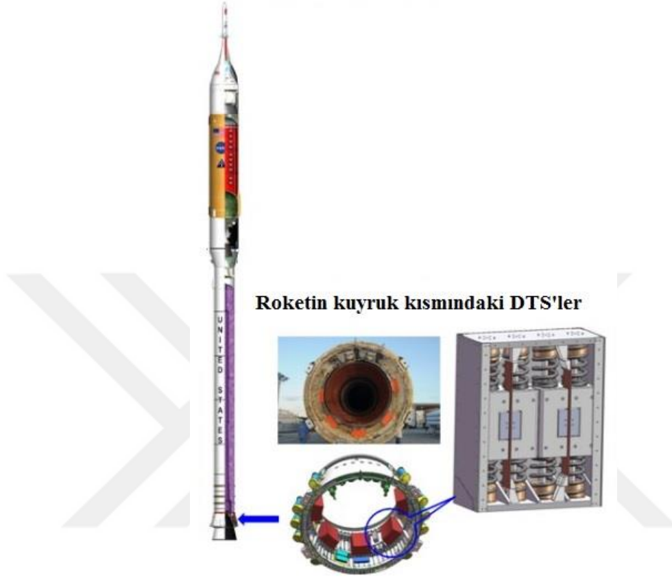
Şekil 1.13. NASA, Ares-I isimli mürettebat taşıma aracının roket çıkışındaki DTS'ler, Nasa (2023)'ten uyarlanmıştır.
