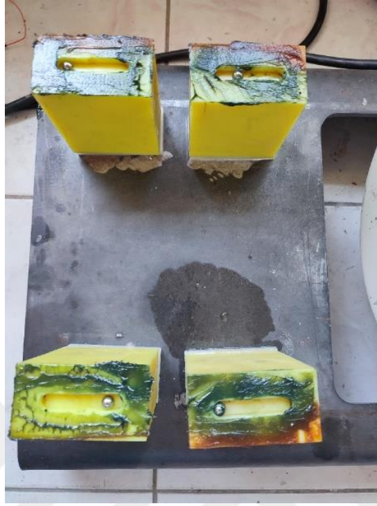
řekil 3.16. Sarsıcı, yatay tabla altındaki polyamid destekler, tabla ile destekler arasına konulan bilyeler ve yaę.
