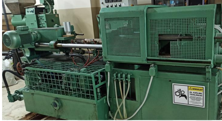
Şekil 3.13: Plastik enjeksiyon makinesi.
