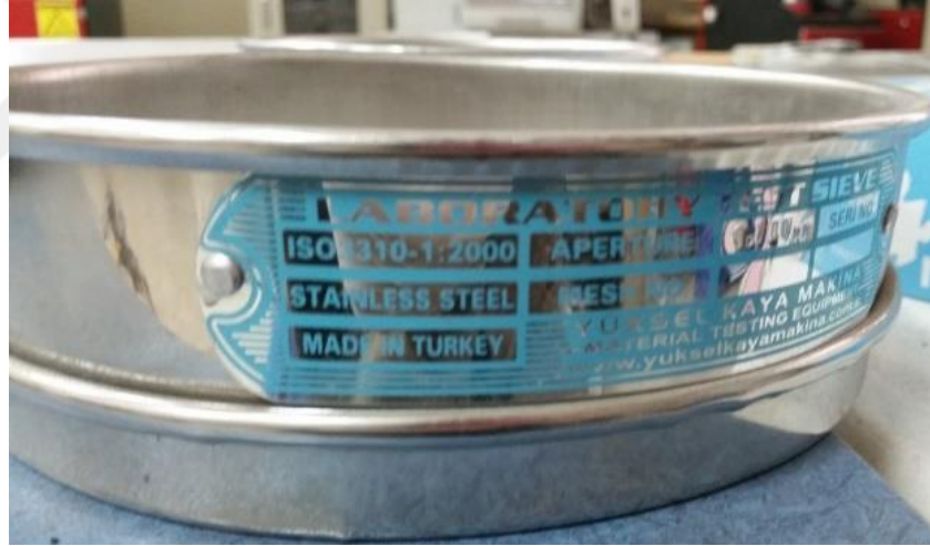
Şekil 3.2: Uçucu külün elenmesinde kullanılan 100 µm elek.
