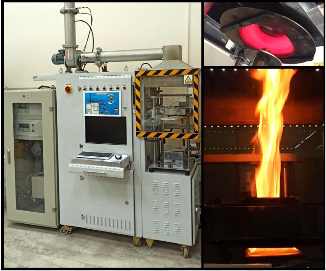
Şekil 3.23: Konik kalorimetre yanma test cihazı.
