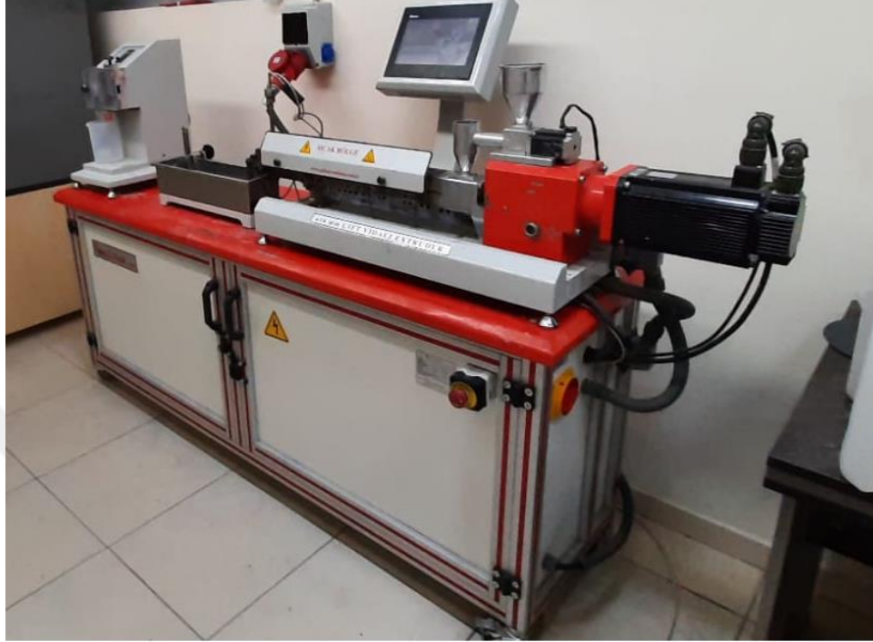
Şekil 3.9: Çift vidalı ekstruder.
