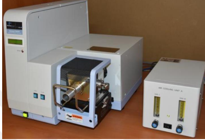
Şekil 3.19: Perkin Elmer Diamond termogravimetrik analiz (TGA) cihazı.
