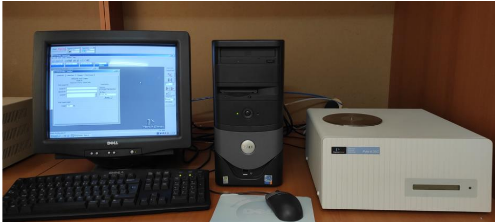
Şekil 3.20: Diferansiyel taramalı kalorimetri (DSC) cihazı.
