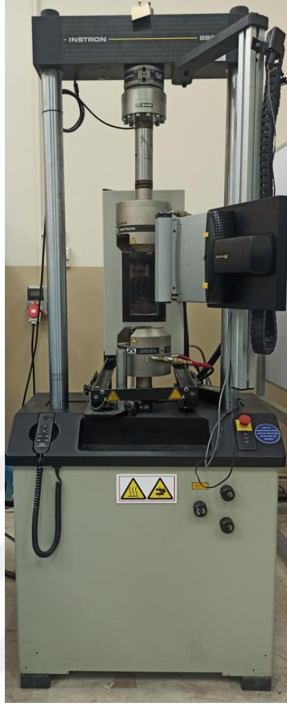
Şekil 3.25: Instron Tester 8801 üniversal çekme test cihazı.
