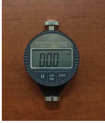
Şekil 3.27: Shore D sertlik ölçüm cihazı.
