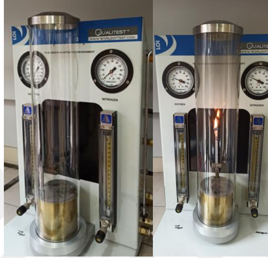
Şekil 3.22: Qualitest marka LOI yanma test cihazı.
