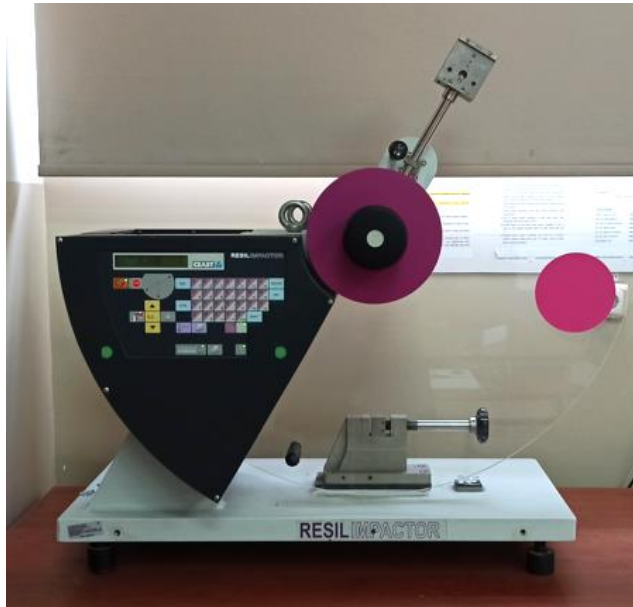
Şekil 3.26: CEAST Izod darbe test cihazı.
