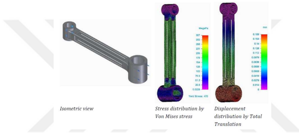
Şekil 1.7 G.D ile Tasarlanan ve CNC İşlemeyle Hafifletilmiş Radyal Motor Rodu [20]
