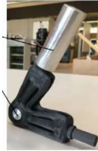
Şekil 2.4 Eİ ile Üretilen Otomobil A Kolu Parçası[35]
