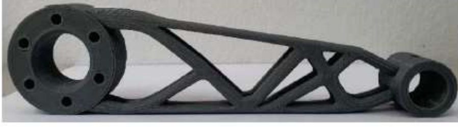
Şekil 2.2 Eİ İle Üretilen Delta Robot Kolu [23].
