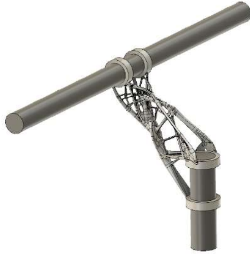
Şekil 1.5 G.D. İle Üretilen Gidon [18]
