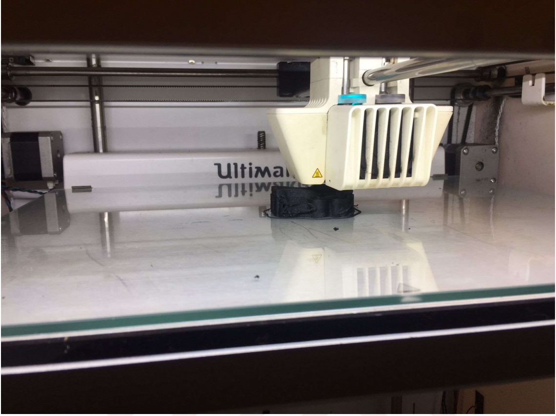
Şekil 5.1 Numuneler FDM Yöntemi ve PA+CF Filament İle Üretilirken
