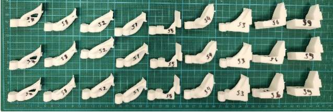
Şekil 5.2 SLS Yöntemi ve PA2200 Toz İle Basılan Parçalar
