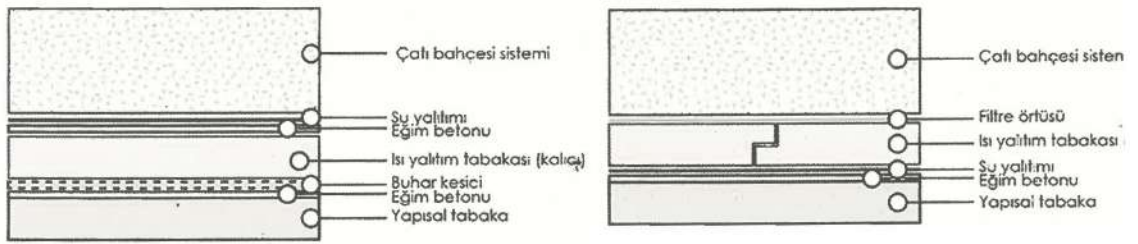
Şekil 2.7 Geleneksel (solda) ve ters çatı (sağda) kesitleri [27]
