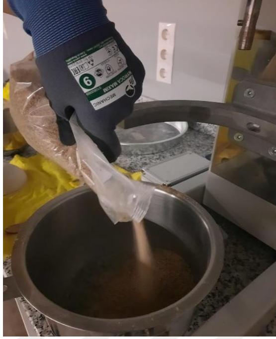
Şekil 12. Harçların Mikserde Karıştırılma Aşaması
