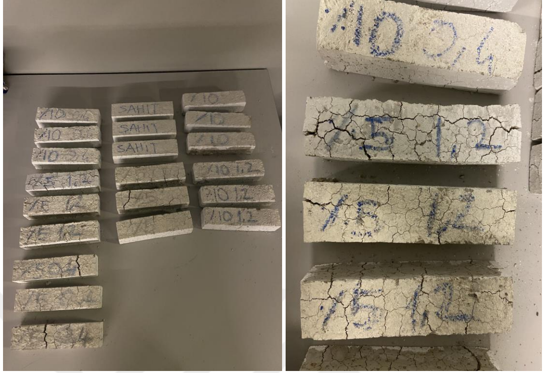
Şekil 25. 900°C Derece Sıcaklığa Maruz Kalmış Numuneler
