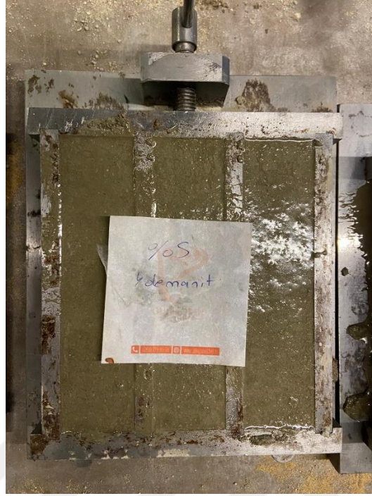
Şekil 15. Harç Numunelerinin Priz Alma Aşaması
