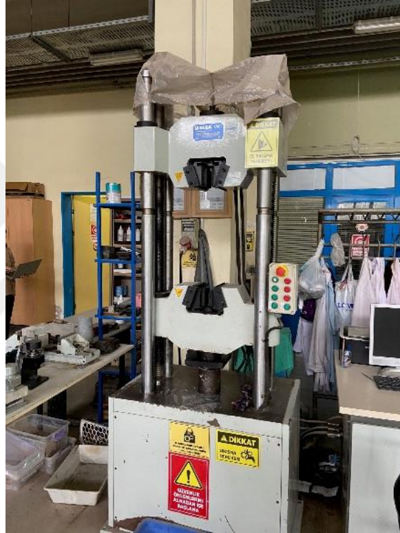
Şekil 21. Kullanılan Beton Presi
