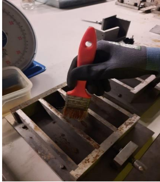
Şekil 11. Kalıpların Temizlenmesi ve Yağlanması Aşaması
