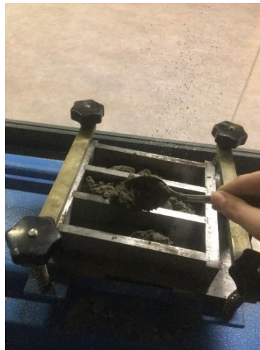
Şekil 14. Harç Numunelerinin Sarsma Tablasına Hazırlık Aşaması
