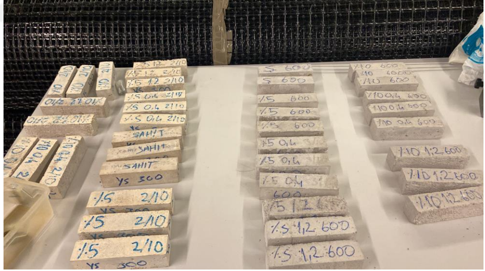
Şekil 24. 300 ve 600°C Derece Sıcaklığa Maruz Kalmış Numuneler
