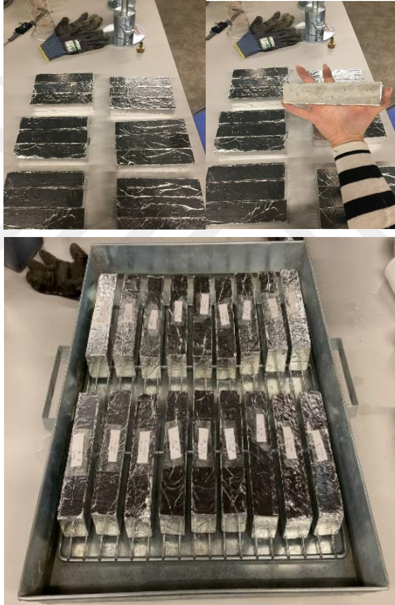
Şekil 20. Kılcallık Deneyi Yapım Aşaması
