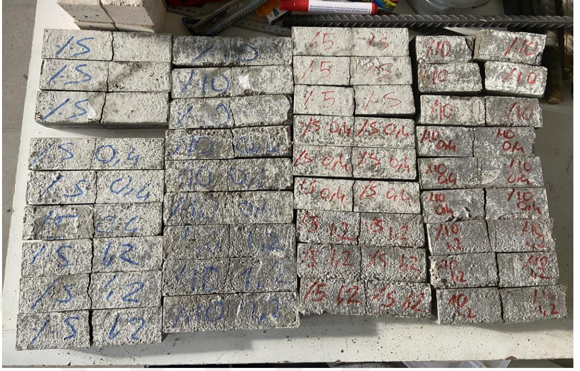
Şekil 27. Eğilme Dayanım Testi Uygulanmış 7 ve 14 Günlük Numuneler
