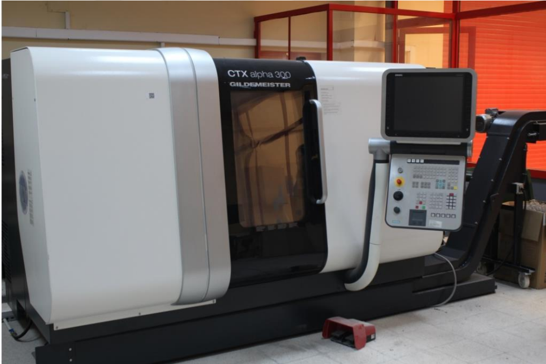
Şekil4.1. DMG Mori Gildemeister CTX Alpha 300 CNC Torna Tezgahı.
