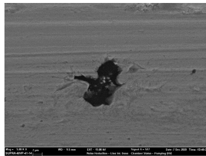
Şekil 5.22. Oda Sıcaklığında Gerçekleştirilen Aşınma Deneyinde Mn ile Alaşımlandırılan KGDD'nin Aşınma Yüzeyinde Deformasyona Uğrayan Küresel Grafit.
