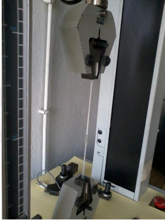
Şekil 3.5. Çekme testi cihazı [10].
