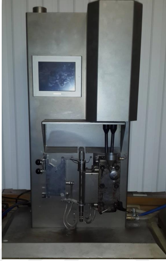
Şekil 3.1. Laboratuvar ölçekli çift vidalı ekstrüder [10].
