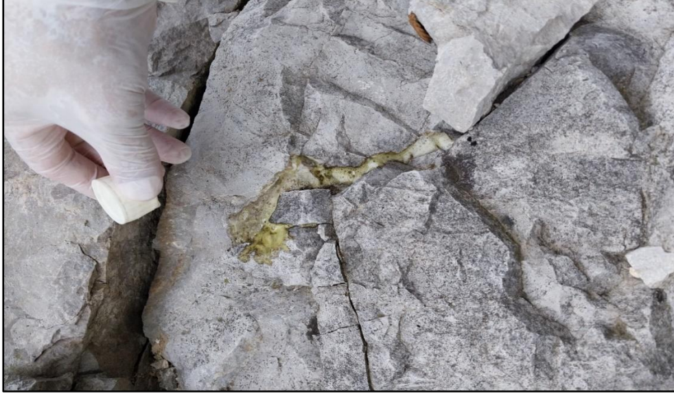
Foto 2: Neritik kireçtaşı olarak bilinen saha arazide gözlemlenmiş, hidroklorik asit ile test edilmiştir.
