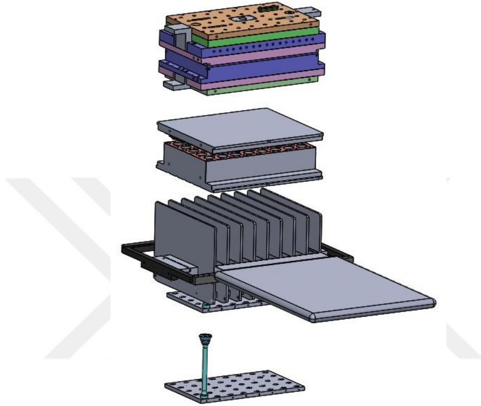
Görsel 4.13: Deliksiz Bir Kapak Kalıbı için Şekilleme, Kesme, Dizme İstasyonları (Görsel Tasarım: Hatice Kübra Kürümoğlu)
