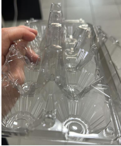
Görsel 4.68: Bayrak Oluşmasının Engellenmesi (Fotoğraf Çekimi: Hatice Kübra Kürümoğlu)
