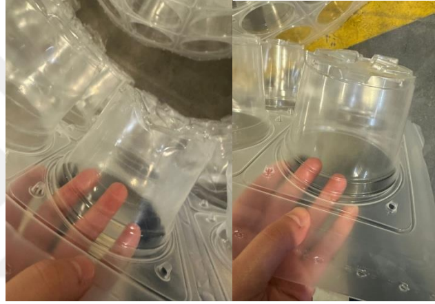
Görsel 4.14: Farklı Hava ve Isı Kullanılarak Şekillendirilen Ürün (Sol: Yanlış, Sağ: Doğru) (Fotoğraf Çekimi: Hatice Kübra Kürümoğlu)
