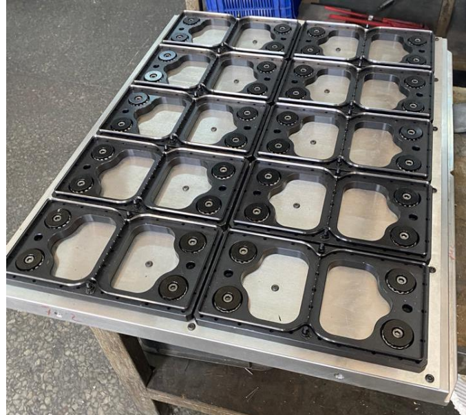
Görsel 4.51: Bıçak Altı (Büte Askılı) (Fotoğraf Çekimi: Hatice Kübra Kürümoğlu)
