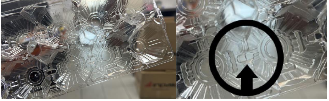
Görsel 4.67: Üründe Bayrak Oluşumunun Gösterimi (Fotoğraf Çekimi: Hatice Kübra Kürümoğlu)
