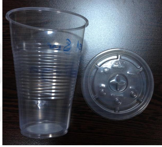
Görsel 3.2: Dişi (Negatif) Bir Kalıp Boşluğuna Basit Vakumla Şekillendirme Fotoğraf Çekimi: Hatice Kübra Kürümoğlu
