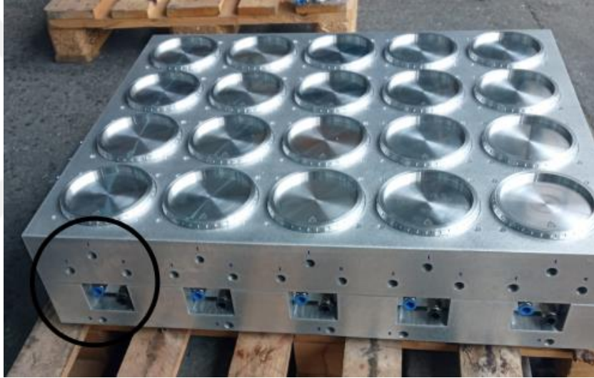
Görsel 4.11: Soğutma için Derin Delinen Deliklerin Gösterimi (Fotoğraf Çekimi: Hatice Kübra Kürümoğlu)
