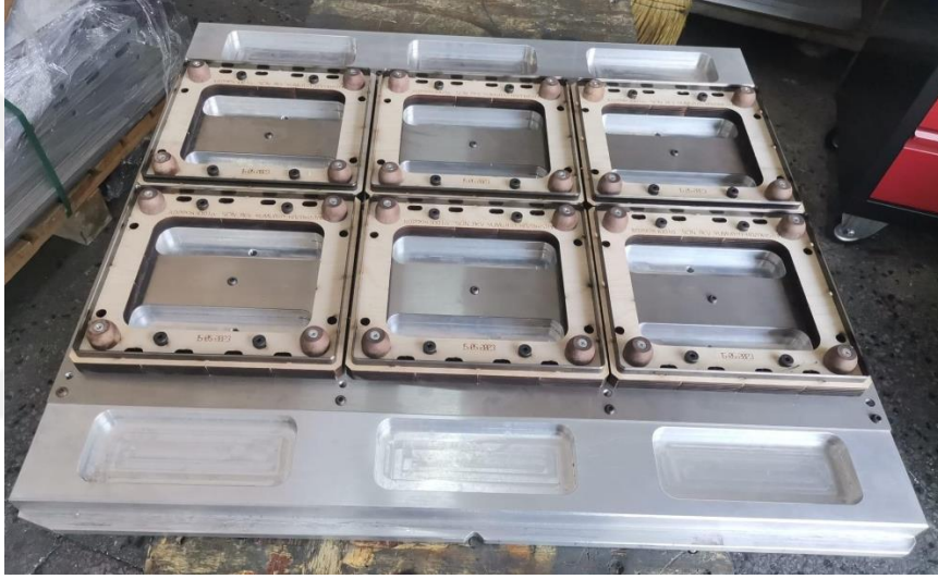
Görsel 4.62: Fiber Merkezlemeli Tahta Bıçaklı Yumurta Bıçak Grubu (TS1000 Makinesi için Üretilen) (Fotoğraf Çekimi: Hatice Kübra Kürümoğlu)
