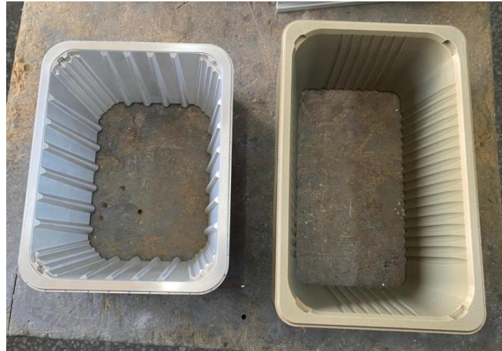
Görsel 4.49: Kaplamasız ve Kaplamalı İnsertler (Fotoğraf Çekimi: Hatice Kübra Kürümoğlu)
