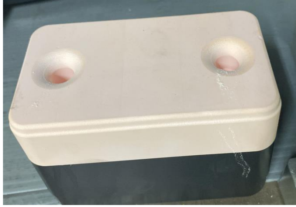
Görsel 4.26: Delrin Adı Verilen Plastiğe Bağlanan Hytac İtici Grubu (Fotoğraf Çekimi: Hatice Kübra Kürümoğlu)
