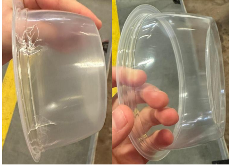
Görsel 4.70: Isı Kullanım Ayarlarının Etkisi Yanlış Isı Kullanılarak Şekillendirilen Ürün ile Doğru Isı Kullanılarak Şekillendirilmiş Ürün (İnpak Makina Bu Teze Katkı Sağlamak Amacıyla Doğru ve Yanlış Şekillendirilen Ürünleri Oluşturmuştur.) (Fotoğraf Çekimi: Hatice Kübra Kürümoğlu)
