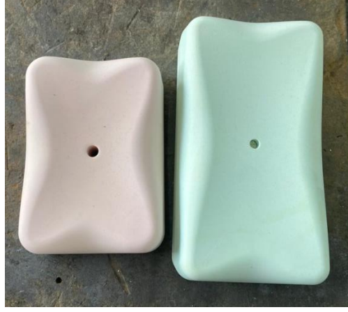
Görsel 4.23: İtici (Plug Assistant) Hytac FLX ve Hytac WFT (Fotoğraf Çekimi: Hatice Kübra Kürümoğlu)
