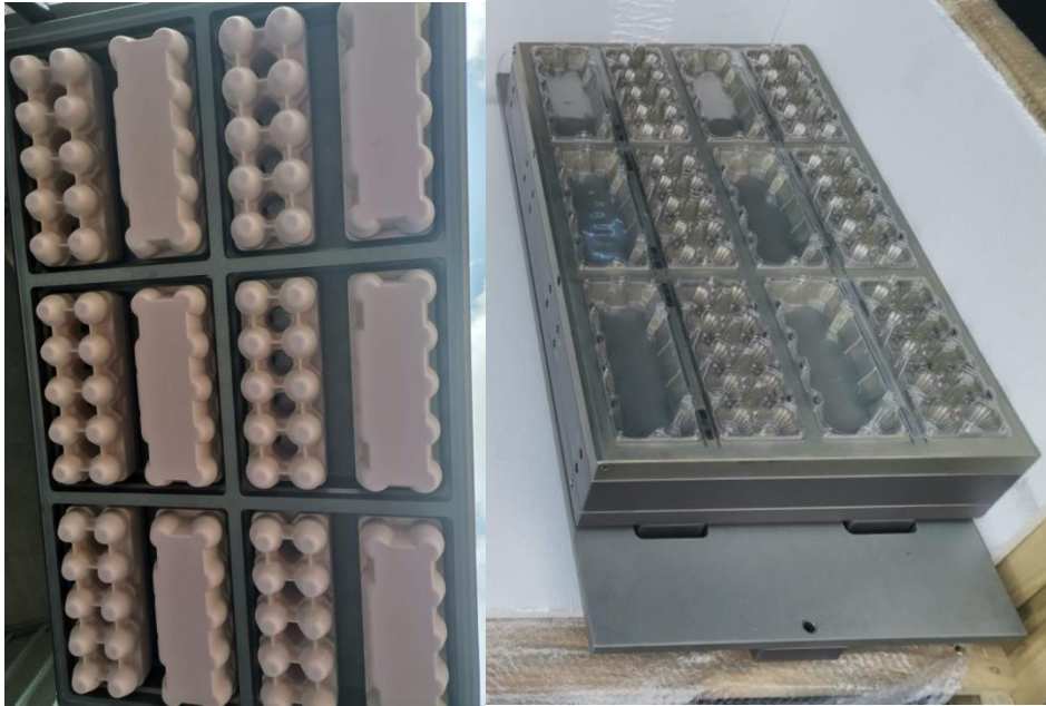
Görsel 4.60: Yumurta Kalıbı Üfleme ve Gövde (TS1000 Makinesinde Çalışan) Sol Tarafta Üretilen Üfleme, Sağ Tarafta ise Üretilen Gövde Kısım (Fotoğraf Çekimi: Hatice Kübra Kürümoğlu)
