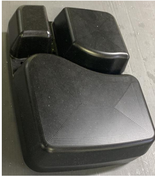
Görsel 4.25: 3 Bölmeli Yemek Kabı için Delrin İtici (Fotoğraf Çekimi: Hatice Kübra Kürümoğlu)
