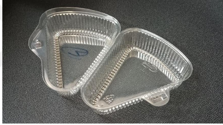
Görsel 3.7: GN Makinesinde Vakum Şekillendirme (Fotoğraf ekimi: euromak, 2023)
