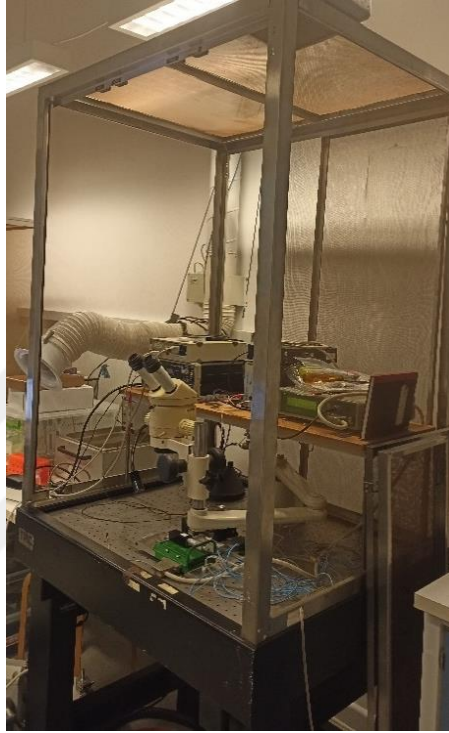
Şekil 18. Faraday kafesi, kafesin içerisindeki H 2 S mikrosensörü takılı izole organ banyosu sistemi ve mikroskop
