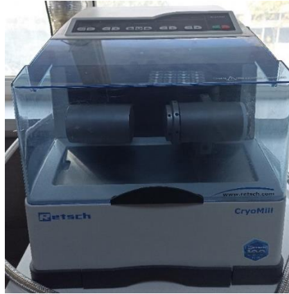
Şekil 8. Kriyojenik öğütme yapan CryoMill cihazı
