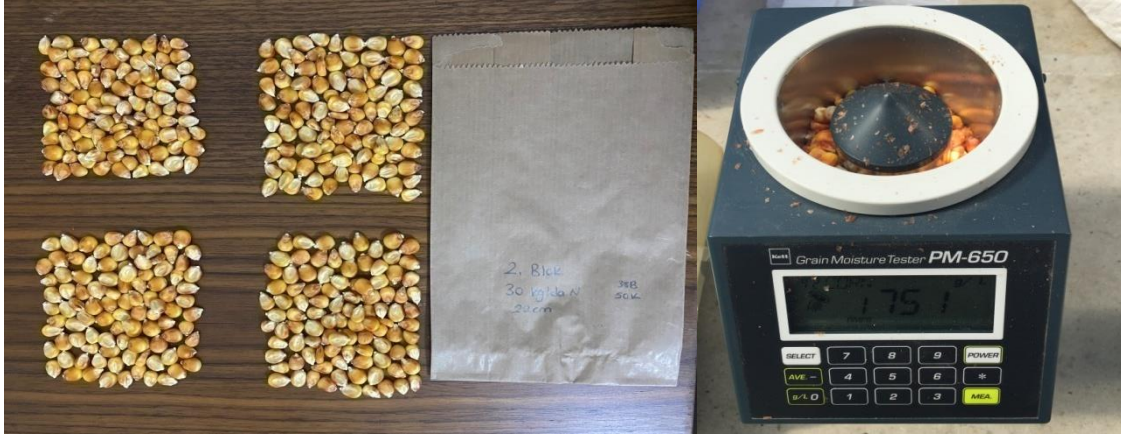
Şekil 3.12. 4 tane 100 tohum sayımı ve hektolitre ağırlığının ölçümü
