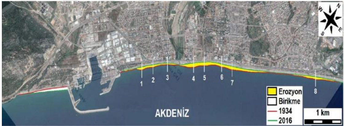
Şekil 4.4. Çalışma Alanının Topografik Harita (1934) ile Uydu Görüntüsünün (2016) Karşılaştırılması (Dipova, 2016)
