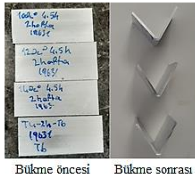
Şekil 6.5 Üç nokta eğme testi uygulanmış numuneler
