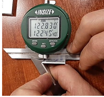
Şekil 6.6 Üç nokta eğme testi sonrası bükme açısı ölçümü
