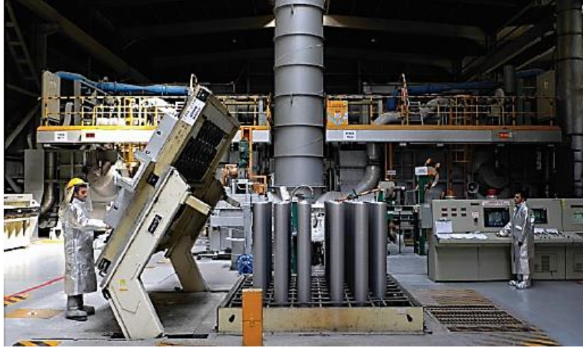
Şekil 3.6 Düşey sürekli döküm ünitesi [39]
