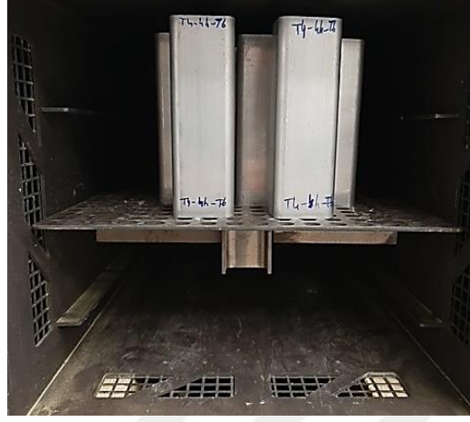
Şekil 5.2 Isıl işlem denemelerinin fırın içi görüntüsü
