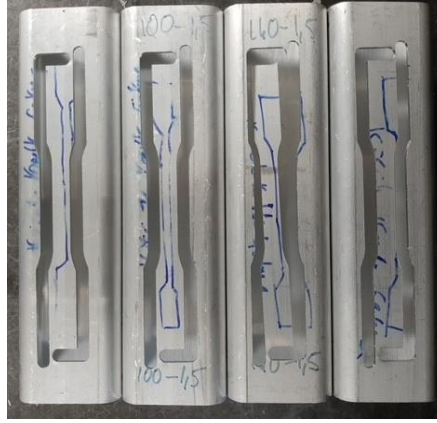
Şekil 5.4 ISO 6892-1 standardına uygun olarak hazırlanan çekme numuneleri
