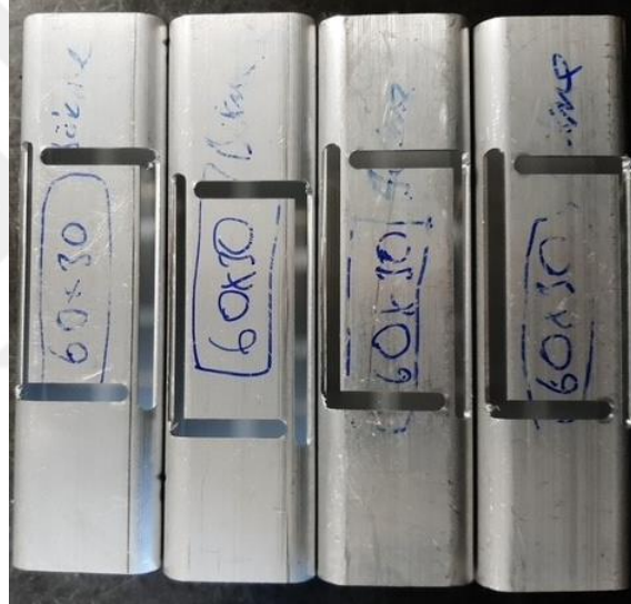
Şekil 5.5 VDA 238-100 standardına uygun olarak hazırlanan bükme numuneleri
