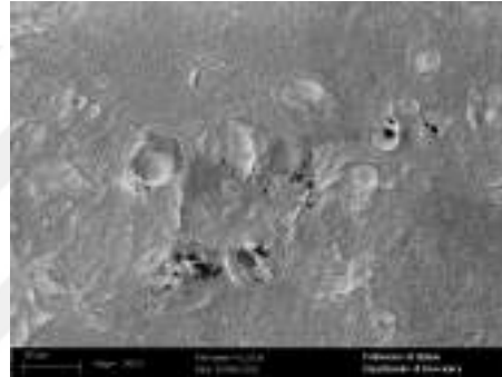
(d) 4 bar, 100mm SoD, 3 seconds - magnification 500X
