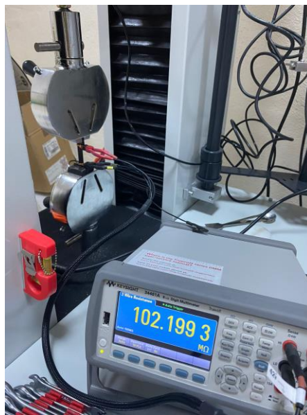
Şekil 3.11. Uzamaya bağlı direnç testi için hazırlanan sistem
