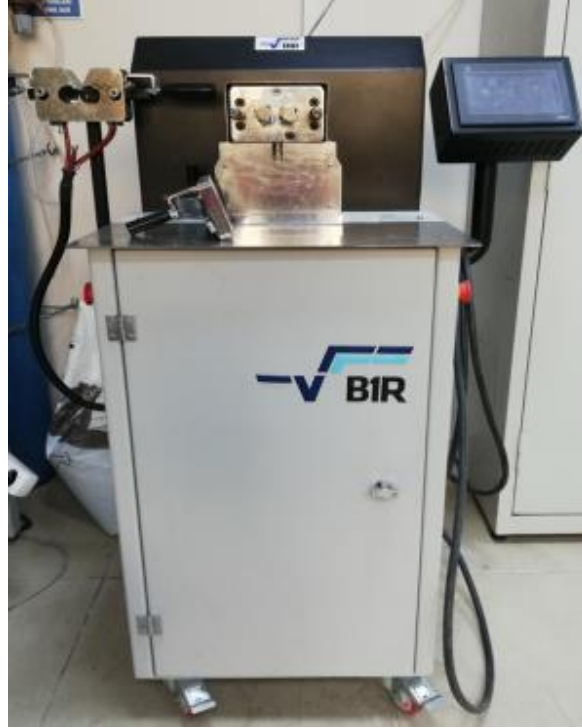
Şekil 3.3. Kompozit yapımında kullanılan Kökbir RTX-M40 marka melt mixer görüntüsü
