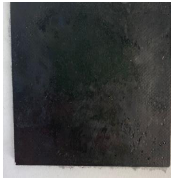
Şekil 3.7. 2mm kalınlığında hazırlanan kompozit bir film örneği
