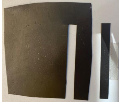
Şekil 3.10. İletkenlik ölçümü için hazırlanan bir örnek ve ölçüm uzunluğu için kullanılan aparat
