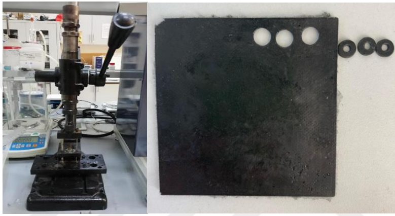
Şekil 3.12. VNA testinde kullanılan numuneleri hazırlamak için kullanılan cihaz ve hazırlanan örnekler
