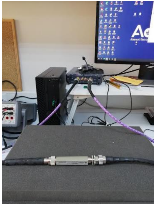
Şekil 3.13. Elektriksel geçirgenlik değerlerinin ölçümünde VNA test düzeneği
