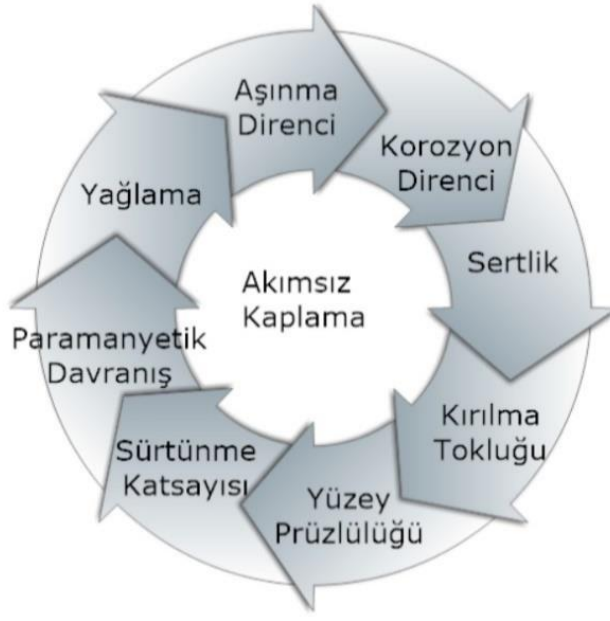
Resim 2.3 Akımsız Ni-P bazlı kompozit kaplamaların fiziksel ve mekanik özellikleri.
