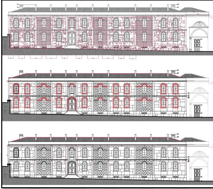
Şekil 132. Ön cephe taş ebatlarına göre numaralandırma çalışması
