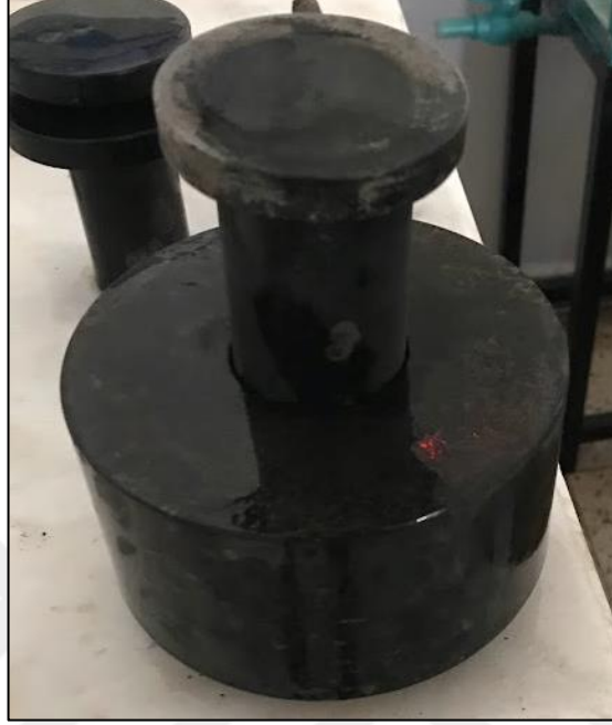
Şekil 3.7. Kalıp sıkıştırma işlemi
