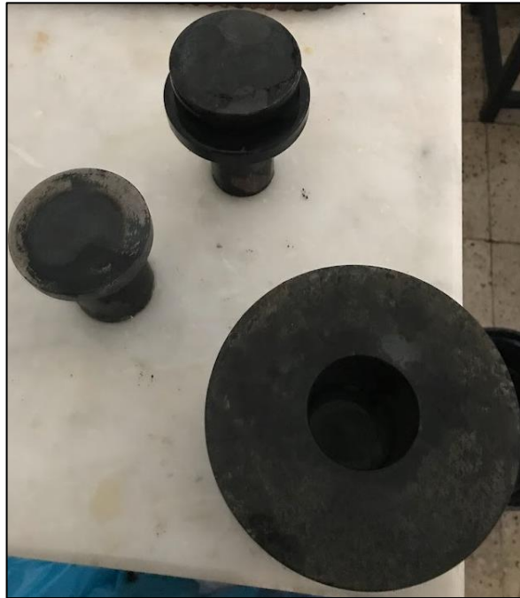
Şekil 0.6. Numune üretimi sırasında kullanılan kalıp örneği
