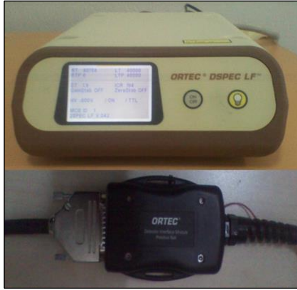
Şekil 3.9. DSPEC LF modülü (üstte) ve yüksek gerilim modülü (altta)
