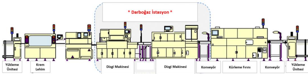
Şekil 1.2: SMT hattı genel süreç akışı (Tsai, 2014).
