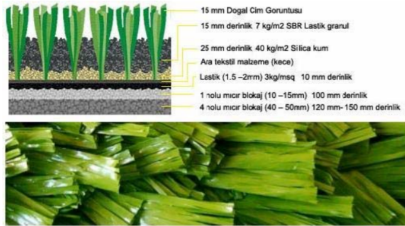
Şekil 2. 3. Polyethylene sentetik çim zeminlerden bir kesit
