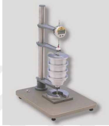
Şekil 4.8. Wira Digital Thickness Gauge ölçüm cihazı.
