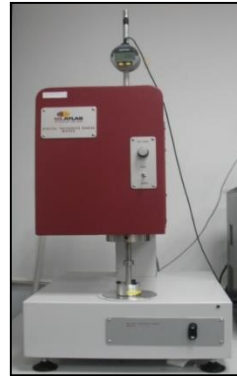
Şekil 4.7. SDL Atlas dijital kalınlık ölçüm cihazı.
