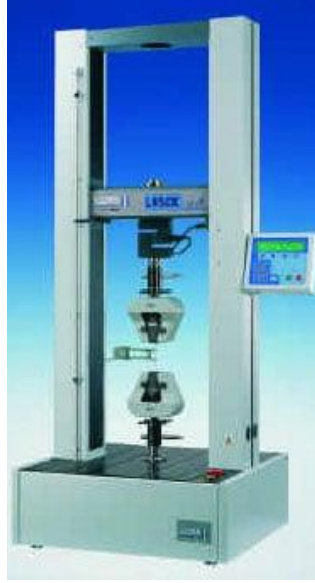
Şekil 4.6. Lyod Instruments kopma mukavemeti test cihazı.
