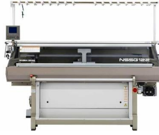
Şekil 4.3. Shima Seiki NSSG 122 SV bilgisayarlı düz örme makinesi.
