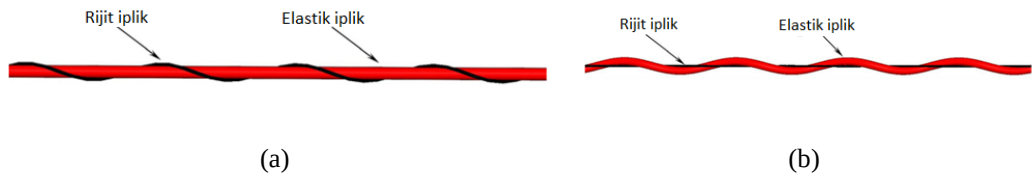
Şekil 2.17. Helis oksetik ipliğin a) Gerilimsiz ve b) Yük altındaki görünümü (Sloan, Wright and Evans, 2011).
