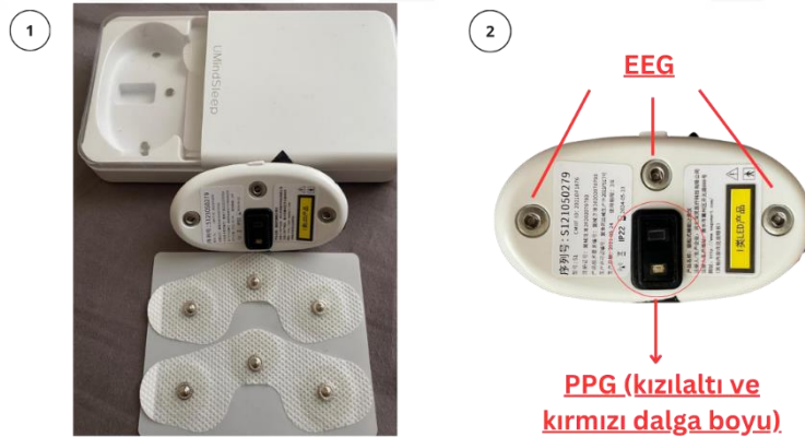
Şekil 6: Tek kanal EEG ve iki dalga boyunu içeren PPG sensörü kombinasyonu.
