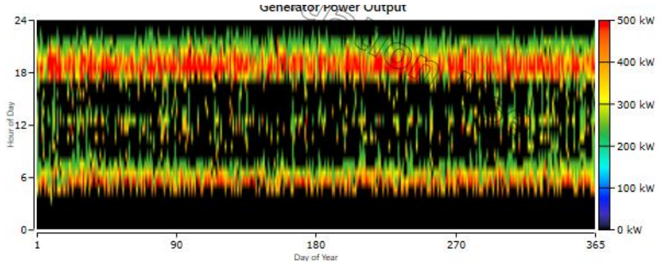
Şekil 4.34. Sistemin Biyogaz Jeneratörü Güç Çıkışı Değerlerini Yıllık Ve Saatlik Üretim Verileri
