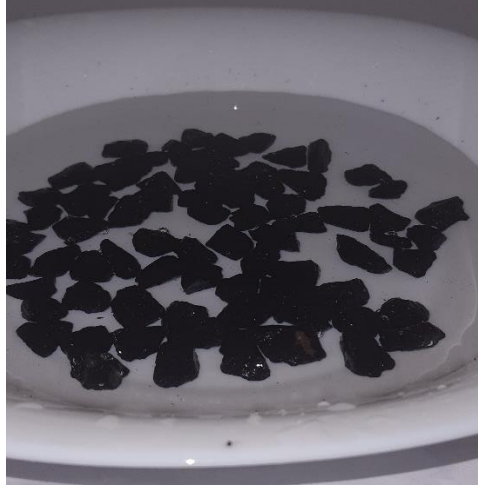
Şekil 6.1 : Görüntülemek üzere saf su dolu derin beyaz tepsi içerisine konulan 1.set bazalt numuneleri.
