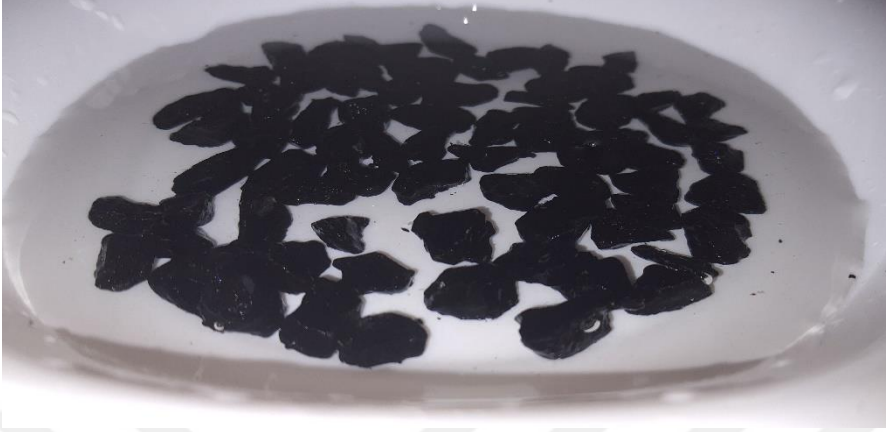
Şekil 6.63 : Görüntülemek üzere saf su dolu derin beyaz tepsi içerisine konulan 5.set kumtaşı numuneleri.
