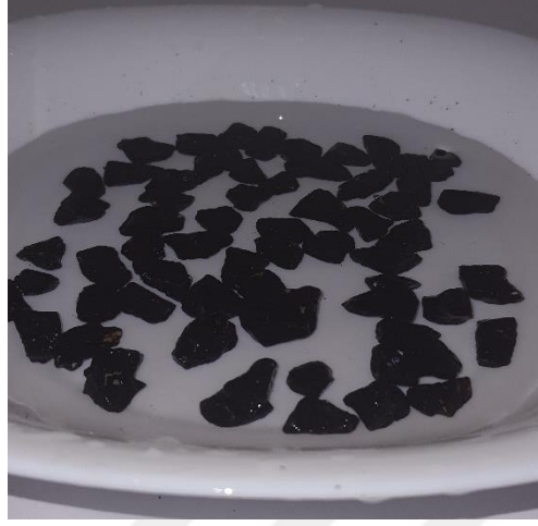
Şekil 6.20 : Görüntülemek üzere saf su dolu derin beyaz tepsi içerisinde konulan 2.set dolomit numuneleri.
