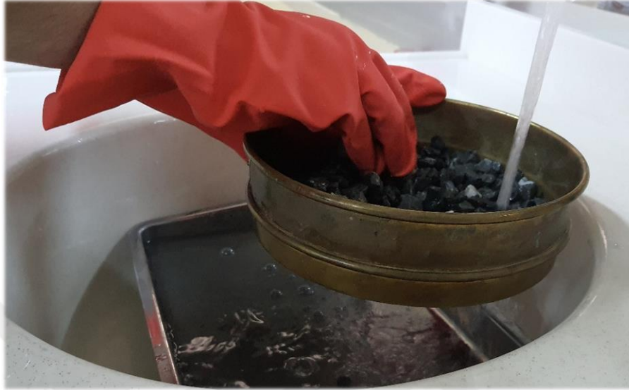
Şekil 5.14 : Agregaların 8 mm'lik elek üzerinde yıkanması.
