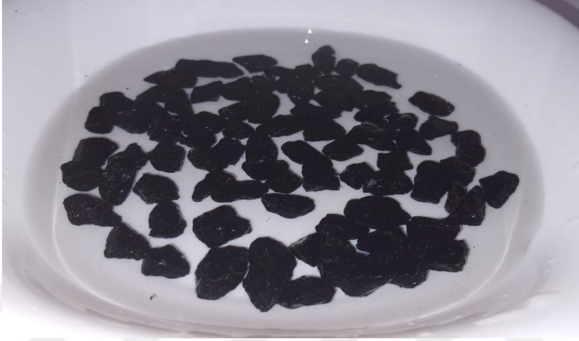
Şekil 6.37 : Görüntülemek üzere saf su dolu derin beyaz tepsi içerisine konulan 3.set kumtaşı numuneleri.
