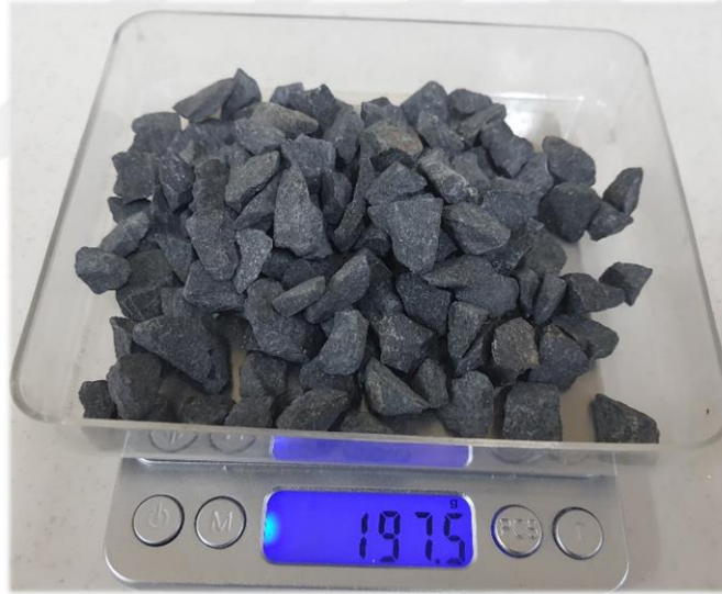
Şekil 5.17 : Yüzey kuru suya doygun 150 adet bazalt agregasının ağırlık ölçümü.
