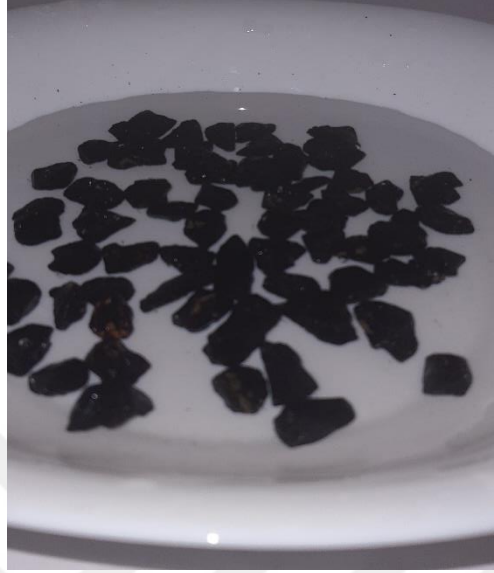
Şekil 6.61 : Görüntülemek üzere saf su dolu derin beyaz tepsi içerisine konulan 5.set kalker numuneleri.
