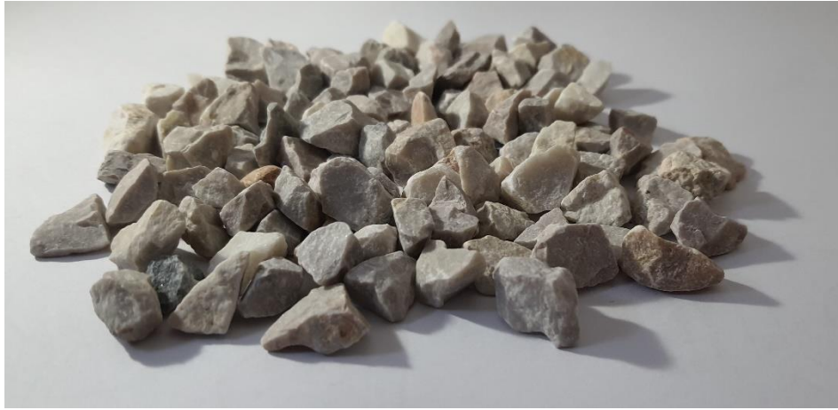
Şekil 5.11 : Deneysel çalışmalarda kullanılan 8-11 mm boyutlarındaki dolomit agregası.
