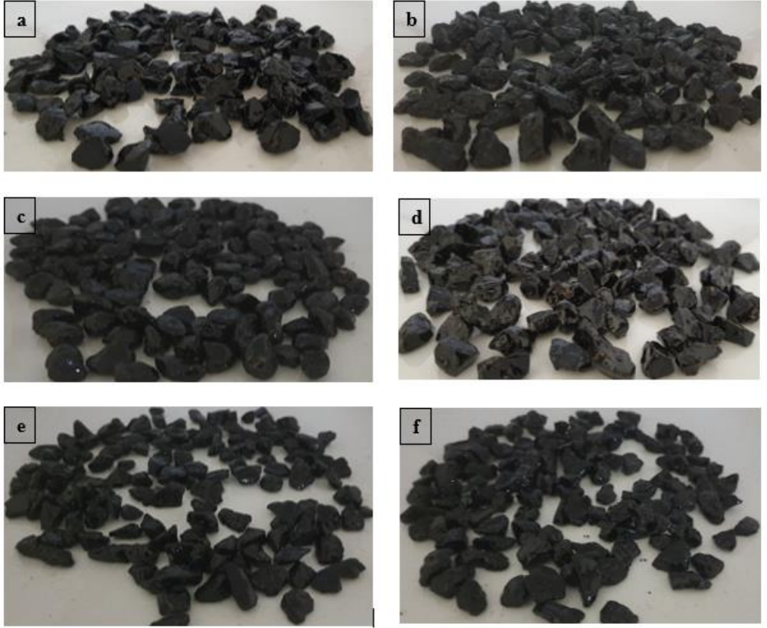
Şekil 5.31 : Görüntüleme için hazırlanan 5.set numuneleri: a) bazalt, b) beyaz kalker, c) çakıl, d)dolomit, e) kalker, f) kumtaşı.
