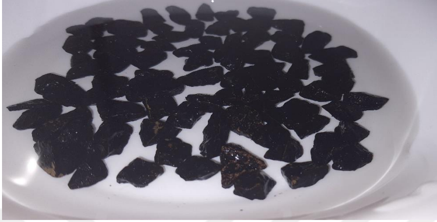
Şekil 6.35 : Görüntülemek üzere saf su dolu derin beyaz tepsi içerisine konulan 3.set kalker numuneleri.
