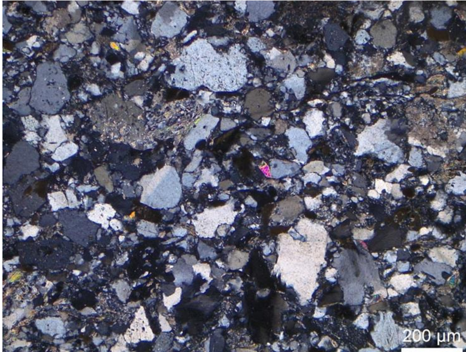
Şekil 5.8 : Kumtaşının petrografik-polarizan mikroskop görünümü.
