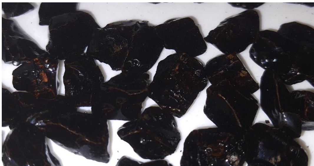
Şekil 6.49 : 4.Set kalker numunelerinin deney sonrası görüntülemeleri.
