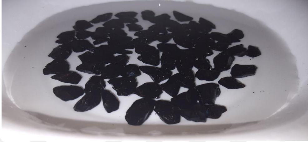
Şekil 6.48 : Görüntülemek üzere saf su dolu derin beyaz tepsi içerisine konulan 4.set kalker numuneleri.
