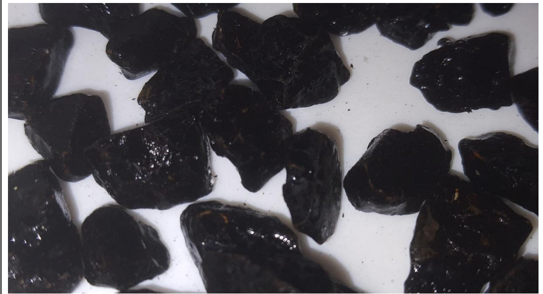
Şekil 6.10 : 1.Set kalker numunelerinin deney sonrası görüntülemeleri.
