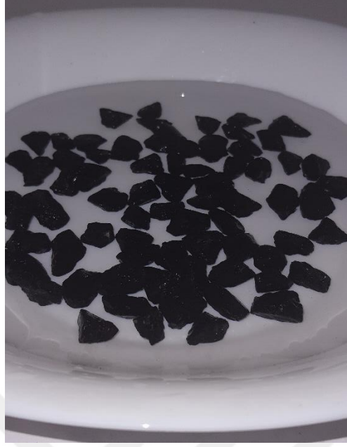
Şekil 6.7 : Görüntülemek üzere saf su dolu derin beyaz tepsi içerisine alınan 1.set dolomit numuneleri.
