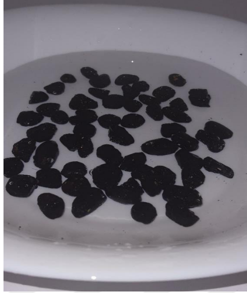
Őekil 6.18 : Grntlemek zere saf su dolu derin beyaz tepsi ierisine konulan 2.set akıl numuneleri.
