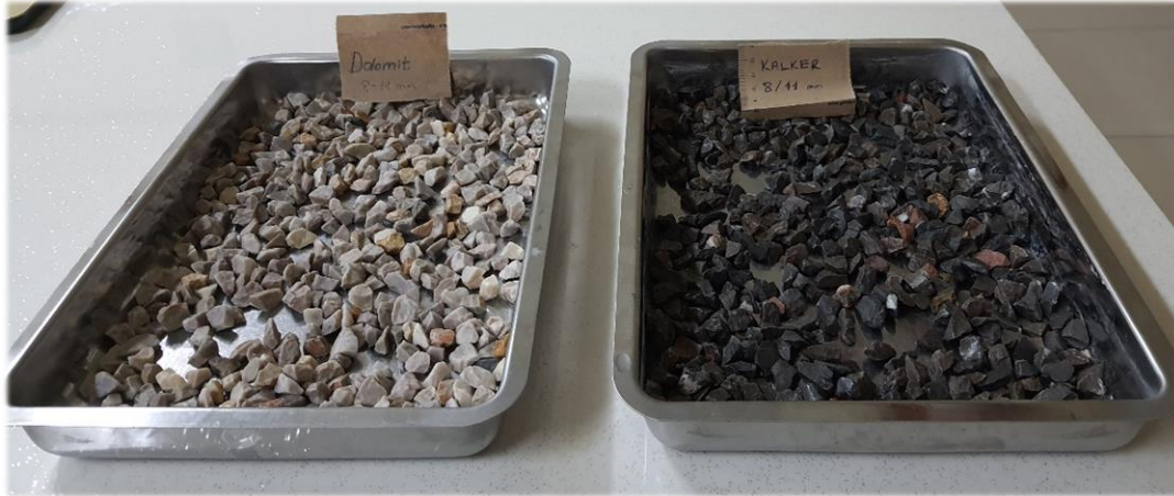
Şekil 5.15 : Yüzey kuru suya doymuş etüv işlemine hazır yıkanmış agregalar.
