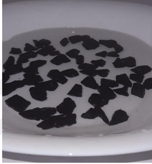
Şekil 6.14 : Görüntülenmek üzere saf su dolu derin beyaz tepsi içerisine konulan 2.set bazalt numuneleri.
