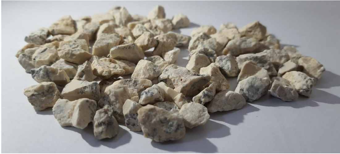
Şekil 5.9 : Deneysel çalışmalarda kullanılan 8-11 mm boyutlarındaki beyaz kalker agregası.
