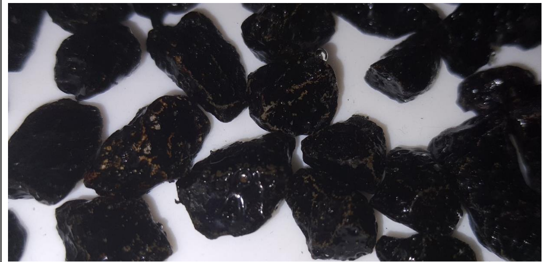
Şekil 6.38 : 3.Set kumtaşı numunelerinin deney sonrası görüntülemeleri.
