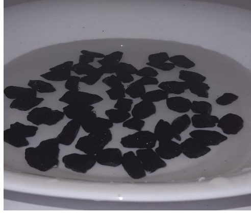
Şekil 6.24 : Görüntülemek üzere saf su dolu derin beyaz tepsi içerisine konulan 2.set kumtaşı numuneleri.
