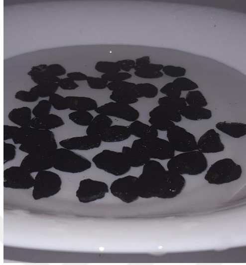
Şekil 6.57 : Görüntülemek üzere saf su dolu derin beyaz tepsi içine konulan 5.set akıl numuneleri.
