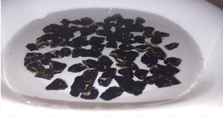
Şekil 6.33 : Görüntülemek üzere saf su dolu derin beyaz tepsi içerisine konulan 3.set dolomit numuneleri.
