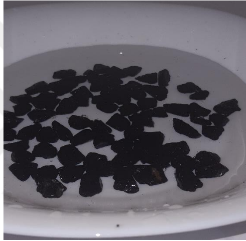
Şekil 6.53 : Görüntülemek üzere saf su dolu derin beyaz tepsi içerisine konulan 5.set bazalt numuneleri.
