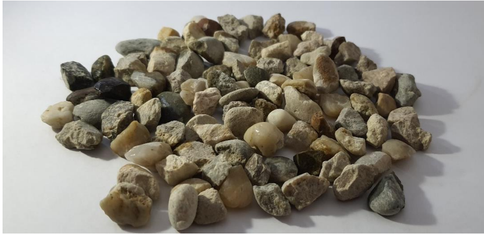
Şekil 5.5 : Deneysel çalışmalarda kullanılan 8-11 mm boyutlarındaki çakıl agregası.
