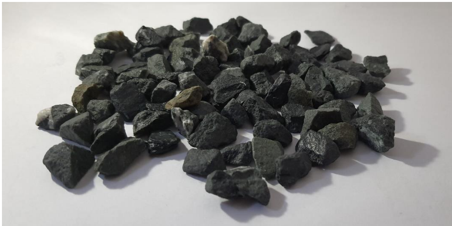
Şekil 5.7 : Deneysel çalışmalarda kullanılan 8-11 mm boyutlarındaki kumtaşı agregası.
