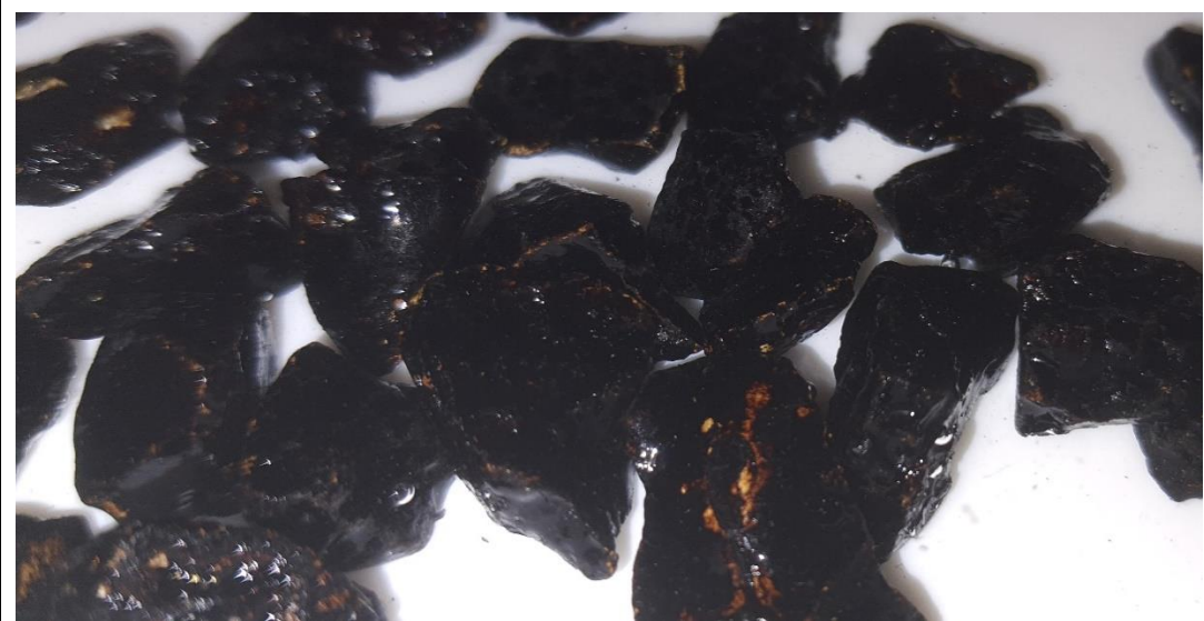
Şekil 6.51 : 4.Set kumtaşı numunelerinin deney sonrası görüntülemeleri.
