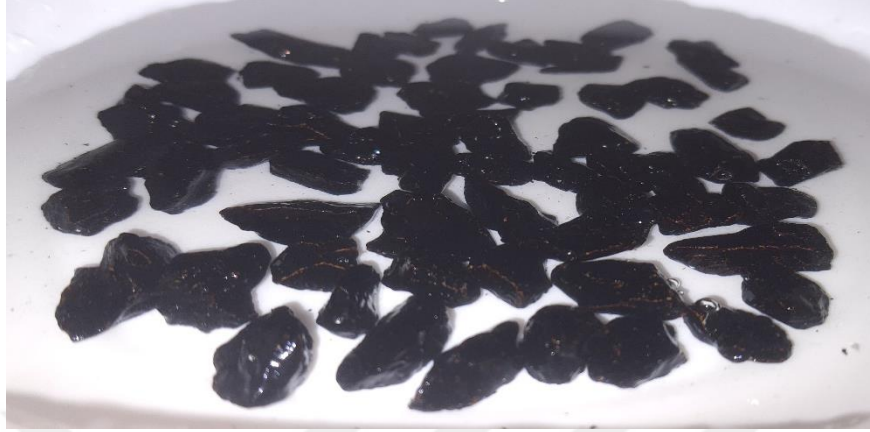
Şekil 6.42 : Görüntülemek üzere saf su dolu derin beyaz tepsi içerisine konulan 4.set beyaz kalker numuneleri.
