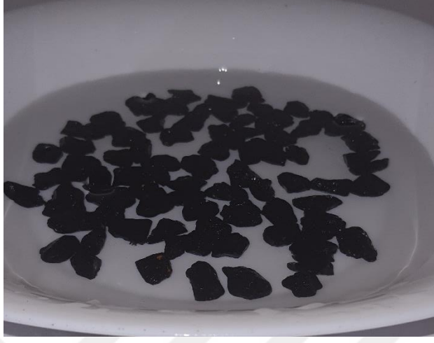
Şekil 6.50 : Görüntülemek üzere saf su dolu derin beyaz tepsi içerisine konulan 4.set kumtaşı numuneleri.
