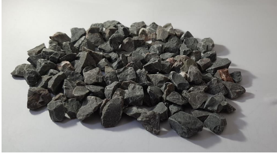
Şekil 5.1 : Deneysel çalışmalarda kullanılan 8-11 mm boyutlarındaki kalker agregası.
