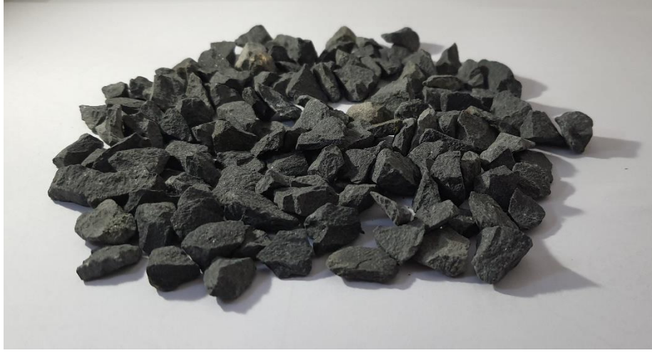
Şekil 5.3 : Deneysel çalışmalarda kullanılan 8-11 mm boyutlarındaki bazalt agregası.
