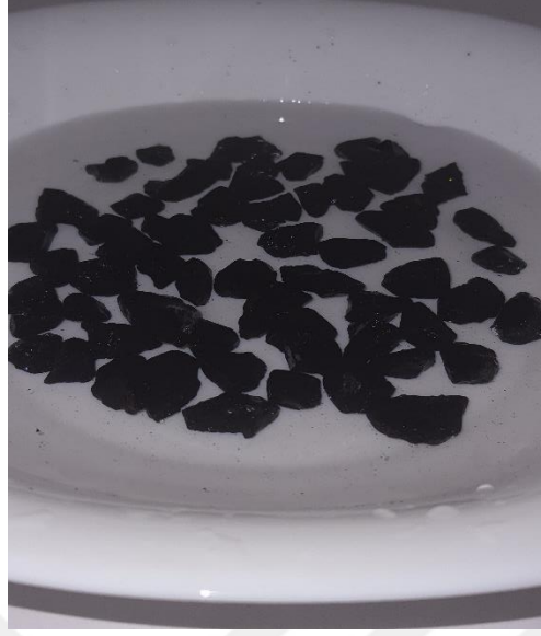
Şekil 6.9 : Görüntülemek üzere saf su dolu derin beyaz tepsi içerisine konulan 1.set kalker numuneleri.
