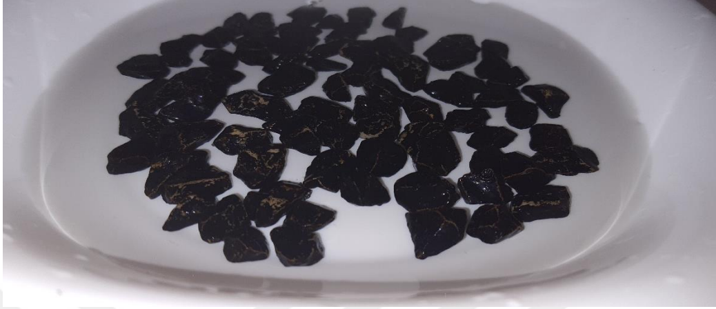
Şekil 6.46 : Görüntülemek üzere saf su dolu derin beyaz tepsi içerisine konulan 4.set dolomit numuneleri.
