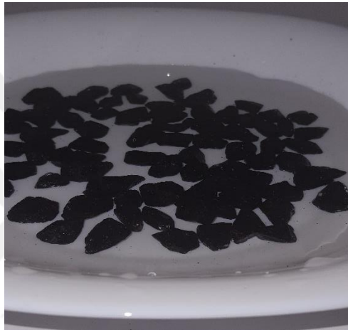
Şekil 6.27 : Görüntülemek üzere saf su dolu derin beyaz tepsi içerisine konulan 3.set bazalt numuneleri.
