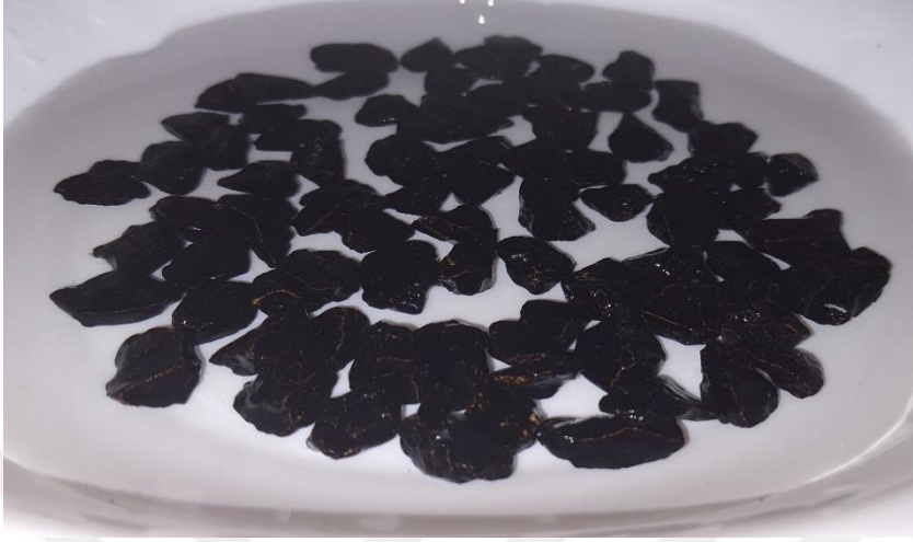
Şekil 6.29 : Görüntülemek üzere saf su dolu derin beyaz tepsi içerisine konulan 3.set beyaz kalker numuneleri.
