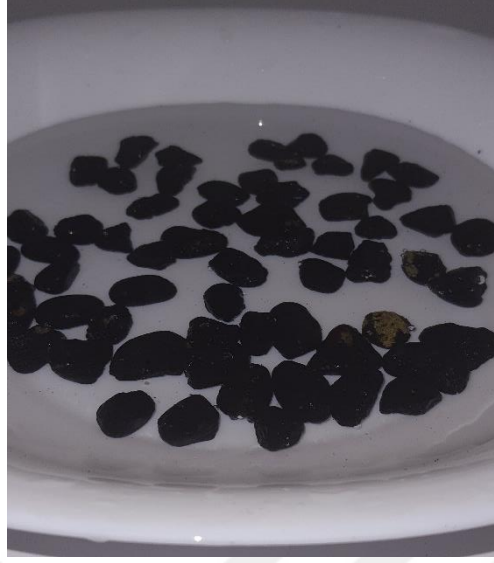
Şekil 6.5 : Görüntülemek üzere saf su dolu derin beyaz tepsi ierisine konulan 1.set akıl numuneleri.
