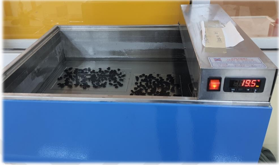
Şekil 5.26 : Isı ayarlı su havuzu içeresinde 48 saat 19°C'de bekletilmek üzere konulan numuneler.
