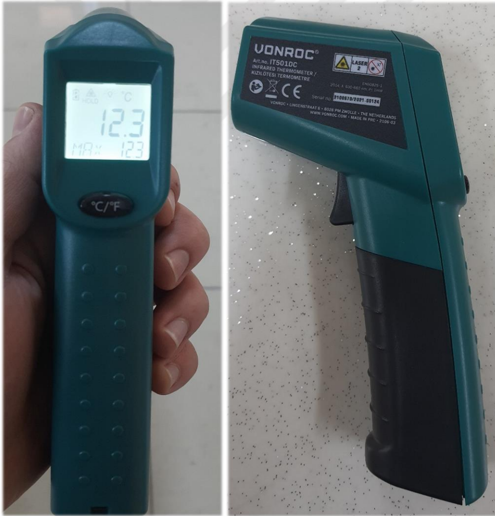
Şekil 5.22 : Deneysel çalışmada kullanılan temassız laboratuvar termoemetresi.
