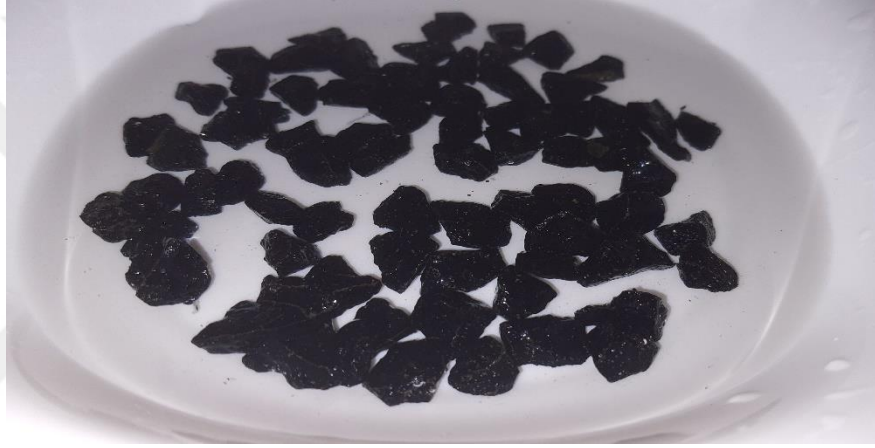
Şekil 6.40 : Görüntülemek üzere saf su dolu derin beyaz tepsi içerisine konulan 4.set bazalt numuneleri.
