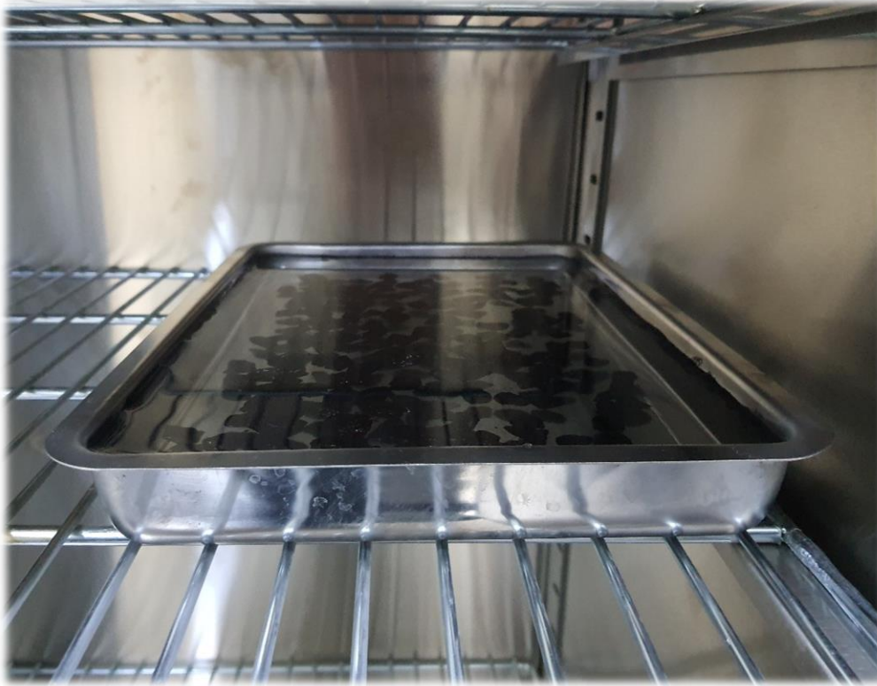
Şekil 5.25 : 24 saat süreyle bekletilmek üzere 60°C 'lik etüvde su dolu derin laboratuvar tepsisi içersine konulmuş numune.
