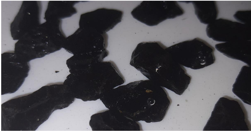
Şekil 6.15 : 2.Set bazalt numunelerinin deney sonrası görüntülemeleri.
