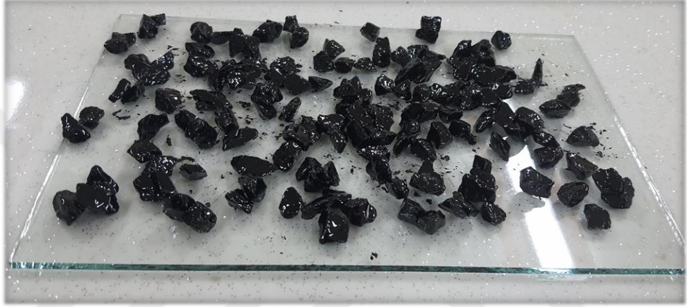
Şekil 5.23 : Üretimi tamamlanmış numunenin laboratuvar ortamında 1 saat beklemesi.
