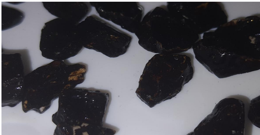
Şekil 6.21 : 2.Set dolomit numunelerinin deney sonrası görüntülemeleri.
