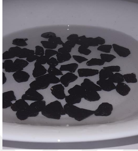
Şekil 6.55 : Görüntülemek üzere saf su dolu derin beyaz tepsi içerisine konulan 5.set beyaz kalker numuneleri.
