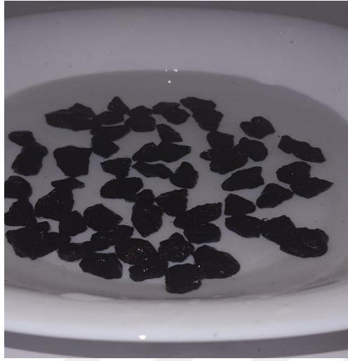
Şekil 6.16 : Görüntülenmek üzere saf su dolu derin beyaz tepsi içerisinde konulan 2.set beyaz kalker numuneleri.
