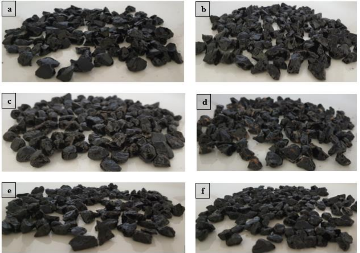
Şekil 5.29 : Görüntüleme için hazırlanan 3.set numuneleri: a) bazalt, b) beyaz kalker, c) çakıl, d) dolomit, e) kalker, f) kumtaşı.
