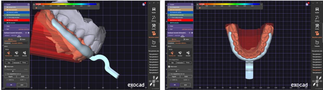
Şekil 3.8. Para-okluzal tutucunun hizalanması ve plak ile birleştirilmesi
