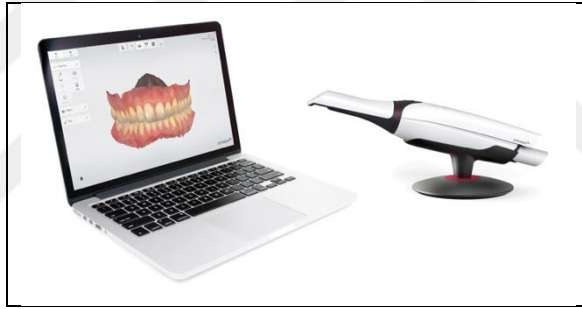
Şekil 3.2. 3Shape Trios4 (TRIOS4; 3Shape A/S, Copenhagen, Denmark) kablosuz ağız içi tarayıcı, (şekil https://www.3shape.com kaynağından alınmıştır)
