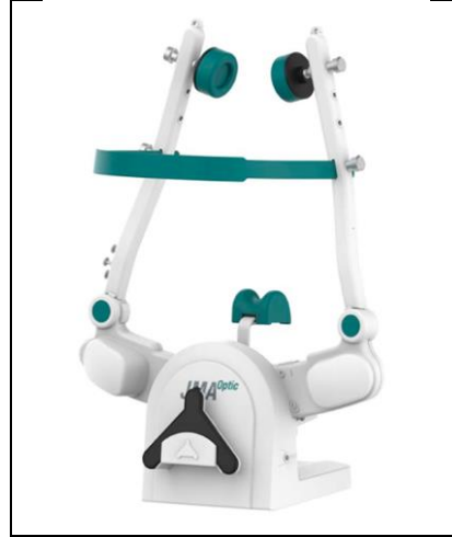
Şekil 3.10. Zebris JMA Optic çene hareket kayıt cihazına ait yüz arkı ve alt çene sensörü (zebris JMA Optic; zebris Medical, Germany), (şekil https://www.zebris.de kaynağından alınmıştır)
