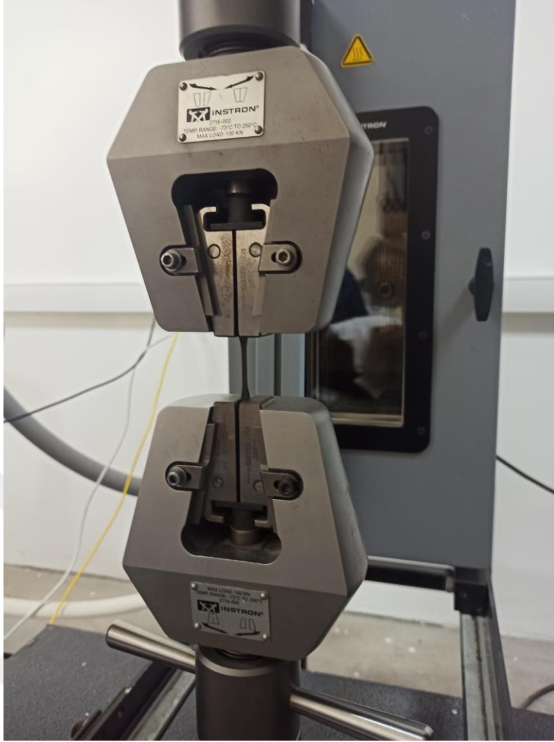
Şekil 2.8 Çekme test düzeneği iklimlendirme kabini
