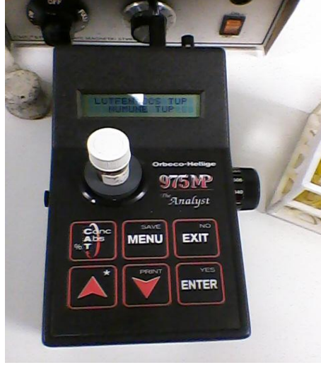
Şekil 4.6 Orbeco-Hellige, Model 975-MP spektrofotometre cihazı
