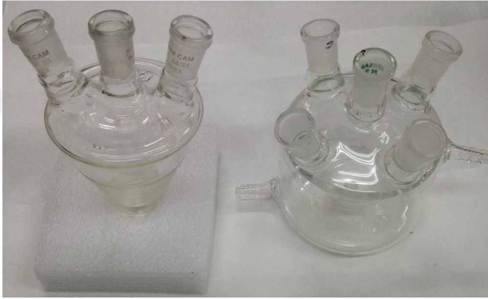
Şekil 2.8. Voltametrik ölçümlerde kullanılan 3 ve 5 boyunlu elektrokimyasal hücreler
