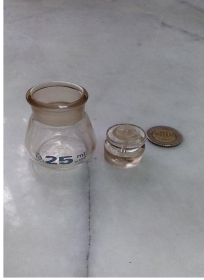
Şekil 4.4. Bitümün özgül ağırlığını tayini için 25 ml'lik piknometre.
