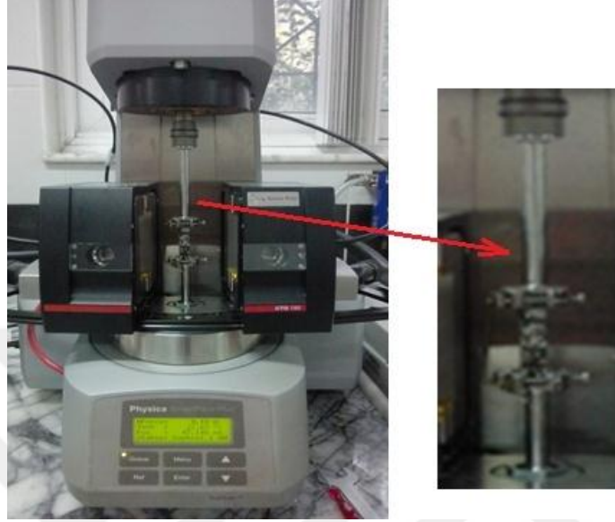
Şekil 5.5. DSR cihazına monte edilen, sıcaklık kontrollü fırın ve kiriş burulma aparatı.
