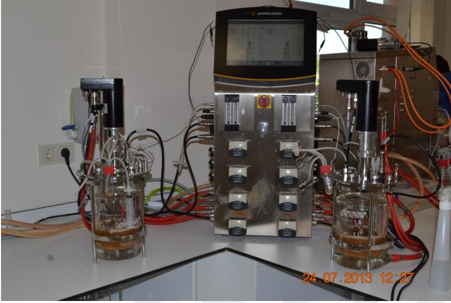
Şekil 4.6. Reaktörde etanol fermentasyonu
