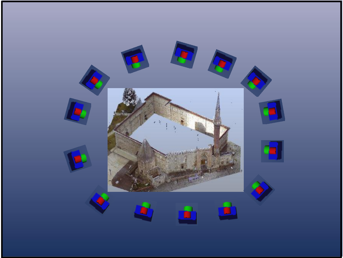
Şekil 4. Yersel fotogrametride fotoğraf alımı
