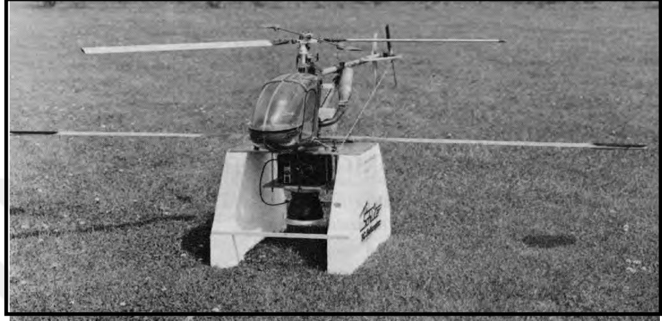
Şekil 24. Döner kanatlı İHA'ların fotogrametrik amaçlı ilk denemeleri
