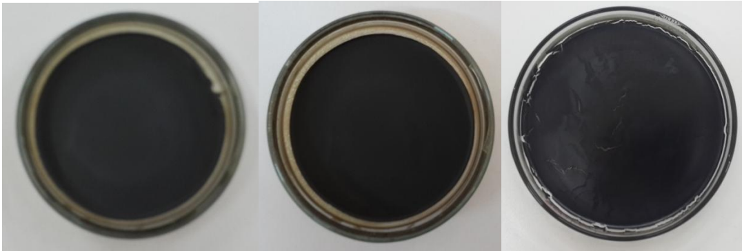
Şekil 4.23. Elde edilen rGO/x -CD ( x = \alpha -, \beta veya \gamma ) yapılarının sentez sonrası kurutulduktan sonra elde edilen katı malzeme
