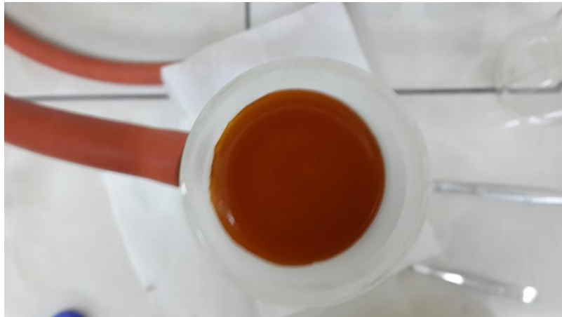
Şekil 4.3. Vakum ile süzülen filtre kağıdı üzerinde elde edilen GO (Filtre gözenağı 0,22\ \mu\text{m} ).
