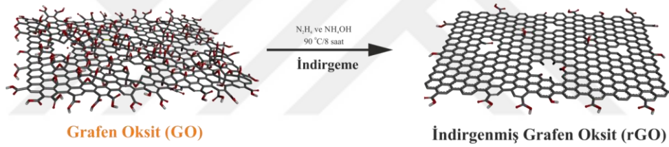
Şekil 3.4. İndirgenmiş grafen oksitin sentez şeması
