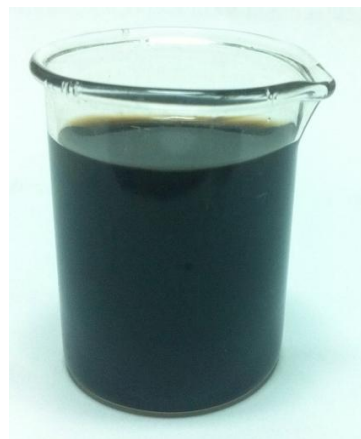
Şekil 4.5. Sentez sonrası elde edilen ve uzun süre ağzı açık beherde bırakılan GO dispersiyonu
