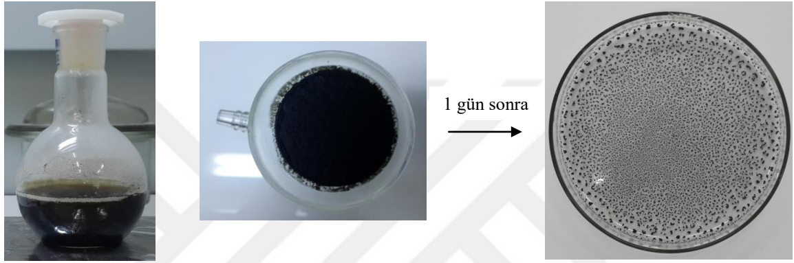
Şekil 4.13. İndirgenmiş grafen oksit (rGO) sentez sonrası çözeltisi, süzme işlemi sonucu elde edilen rGO ve petri kabında kurutulduktan sonra elde edilen toz rGO
