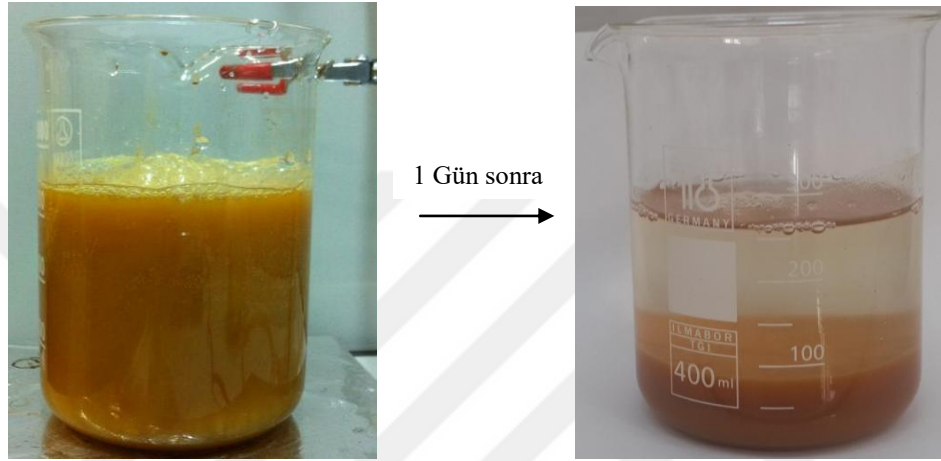
Şekil 4.2. Geliştirilmiş Hummers metoduna göre sentezlenen GO ve 1 gün bekletildikten sonra oluşan çökeltisi
