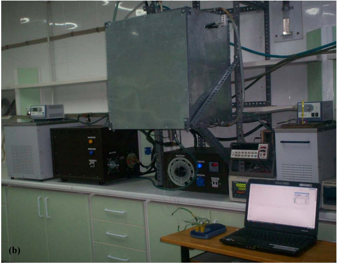
Şekil 3.3. Radyal ısı akış sisteminin (a) diyagramı [13], (b) fotoğrafı.
