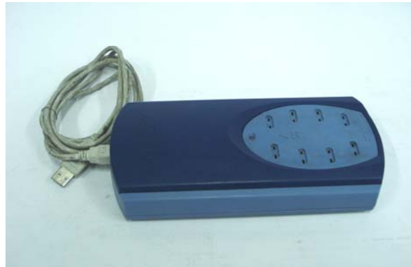
Şekil 3.16. Sıcaklıkların kaydedilmesinde kullanılan Pico TC-08 marka cihaz.
