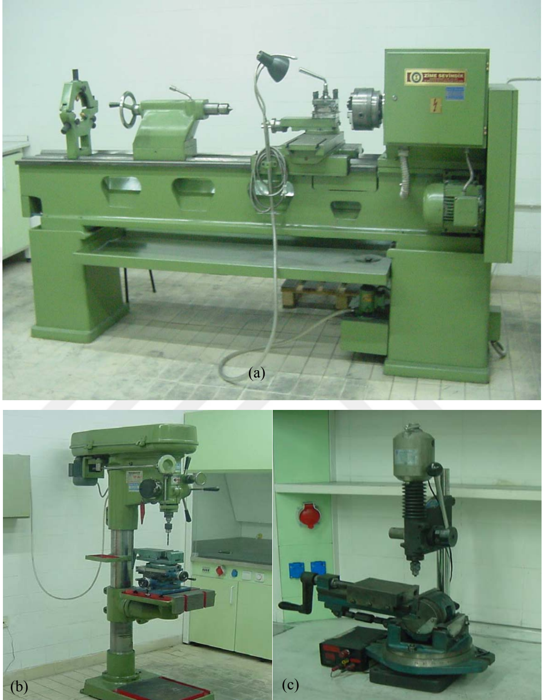
Şekil 3.10. Kalıp yapımında kullanılan torna ve matkap fotoğrafları. a)Torna tezgahı, b) Sütunlu matkap, c) Masaüstü matkap.
