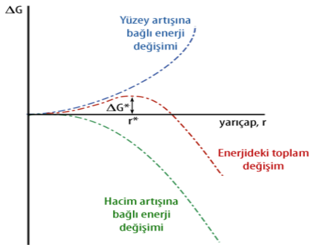
Şekil 2.2. Homojen çekirdeklenmede embriyonun serbest enerjisinin çekirdekçğin yarıçapına bağlılığı [8].
