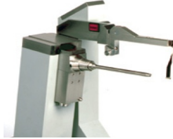
Şekil 2.3 Tek dalgaboylu x-ışını kaynağının şekil üzerinde gösterimi.
